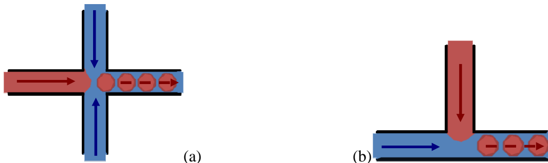
Figure 15 : Schéma de formation de gouttes en microfluidique, formation par flow focusing (a) et formation par cross flowing (b)
