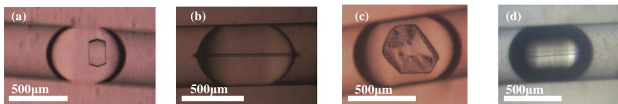
**Figure 60 : Photographie de gouttes contenant des cristaux dans le nouveau système microfluidique basé sur la technique des capillaires : (a) Cristal de lysozyme 30mg/ml à 20°C dans un tampon aqueux de 0,7M NaCl pH = 4,5 ( $\beta=9,5$ ) ; (b) Cristal de caféine dans l'éthanol 7mg/ml à 20°C ( $\beta=2$ ) ; (c) Cristal d'isonicotinamide dans l'éthanol 143mg/ml à 10°C ( $\beta=2,25$ ) ; (d) Cristal d'isonicotinamide dans le nitrobenzène 7mg/ml à 10°C ( $\beta=2$ )**
