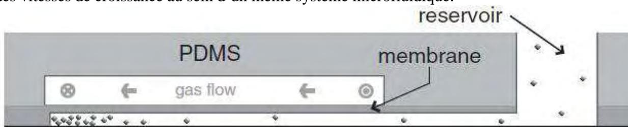
Figure 18 : Schéma de principe du microévaporateur, d'après Leng<sup>27</sup>
