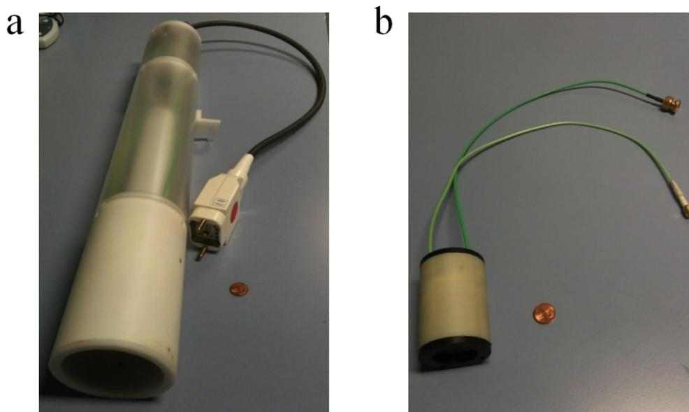
**Figure F.V.2 : Antennes radiofréquences  $^1\text{H}$ .** L'antenne volumique Bruker (a) a été utilisée pour les expériences *in vitro*. L'antenne quadrature volumique (b) a été développée dans le laboratoire d'électronique et a été utilisée pour les expériences chez la souris.
