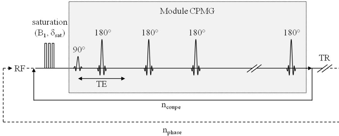
**Figure F.V.3 : Schéma de la séquence CEST-MSME.**
