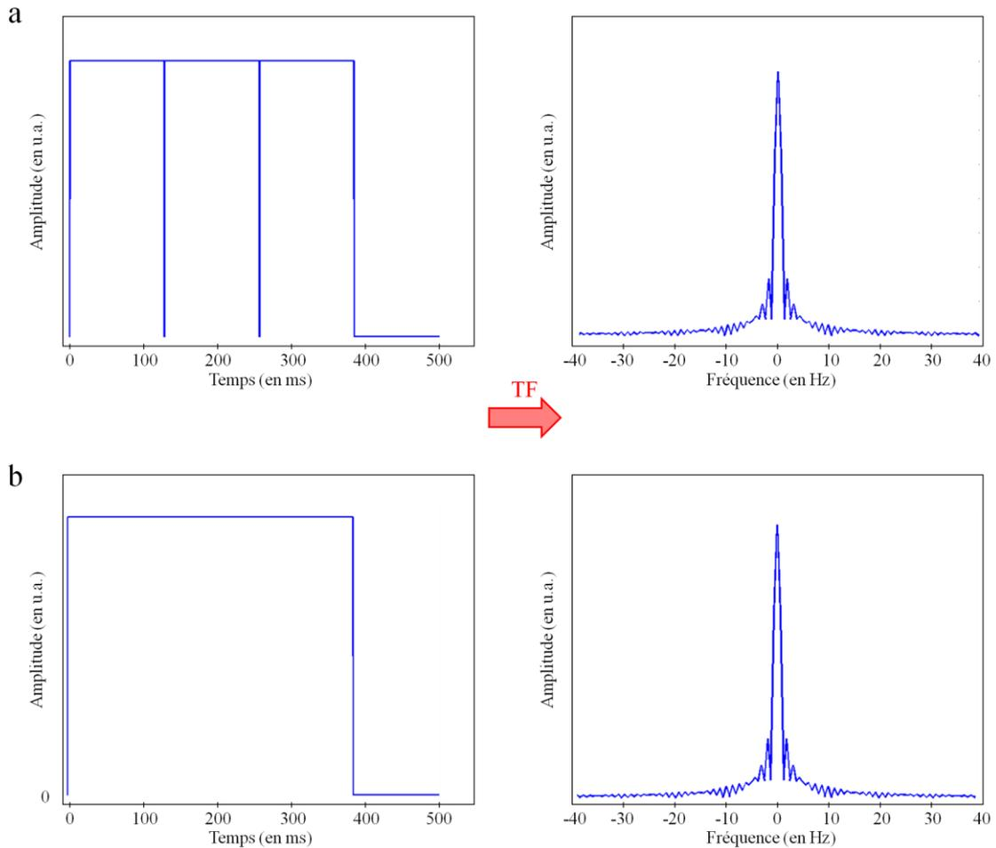
**Figure F.V.6 : Profil spectral du module de saturation.** La largeur à mi-hauteur de la transformée de Fourier d'un train de 3 impulsions carrées de 128 ms (a) est de 4 Hz ce qui est équivalent à ce qui aurait été obtenu pour une unique impulsion carrée de 384 ms (b).
