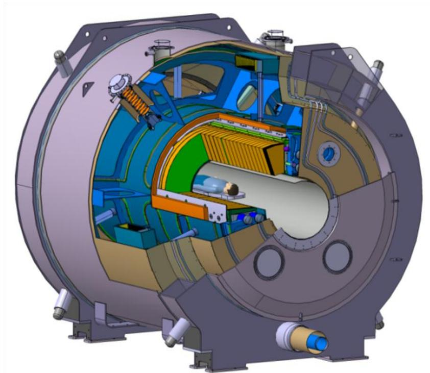
**Figure F.I.2 : Vue en coupe du futur imageur 11,75T. Les bobines supraconductrices sont représentées en orange, le cryostat en bleu et la structure mécanique en gris. L'ouverture sera de 90 cm, permettant le passage du corps entier du volontaire.**
