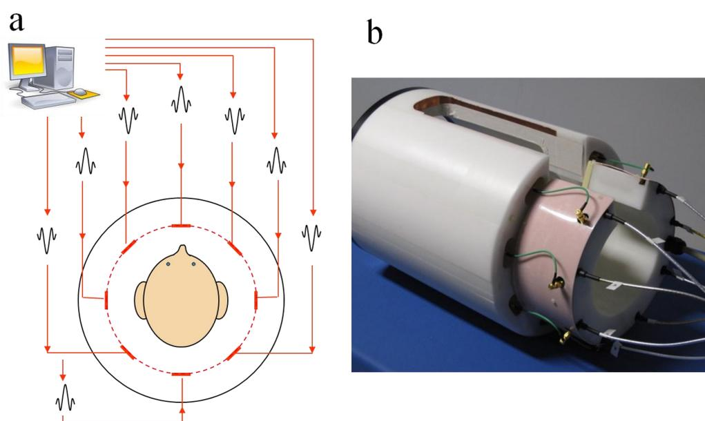
**Figure F.I.3 : Principe du RF shimming statique.** (a) Une impulsion RF est appliquée sur chaque canal avec une amplitude et une phase propre grâce à une électronique dédiée multi-canaux. (b) Prototype d'antenne réseau à 8 canaux dédiée à la transmission parallèle.
