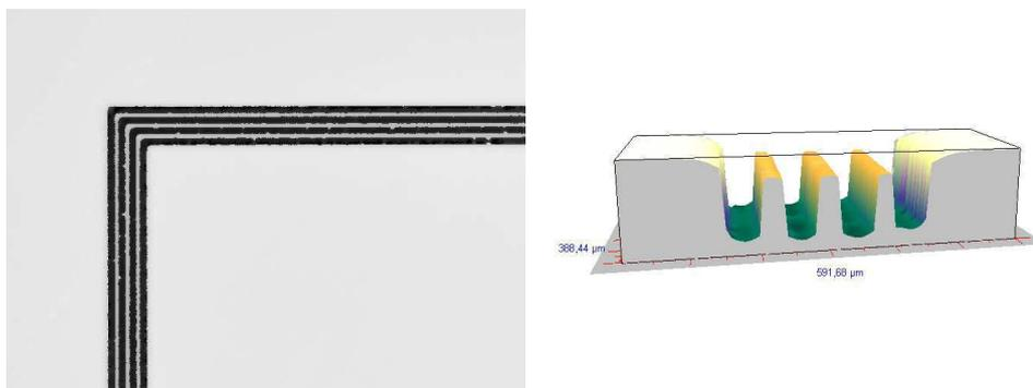
(a) Photo de la carte des profondeurs : les zones noires sont gravés, et les zones grises sont non-gravées. (b) Coupe 3D de la figure 3.26a obtenue à l'aide du profilomètre.
