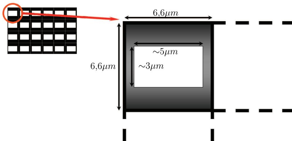
FIGURE 3.5 – Dimension d’un pixel au niveau de la photorésine, après réduction d’un facteur 5 : 1.
