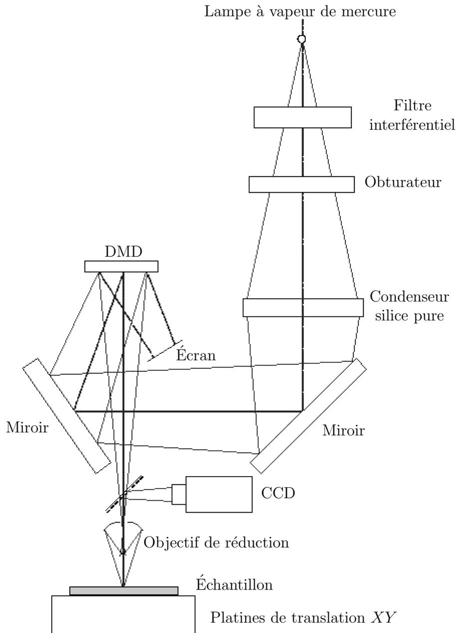
FIGURE 4.1 – Schéma de principe du phototraceur massivement parallèle à base de DMD de Mélanie Kessels.
