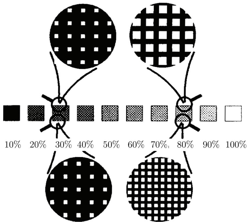
FIGURE 1.7 – Photolithographie 3D par filtrage spatial. [17]
