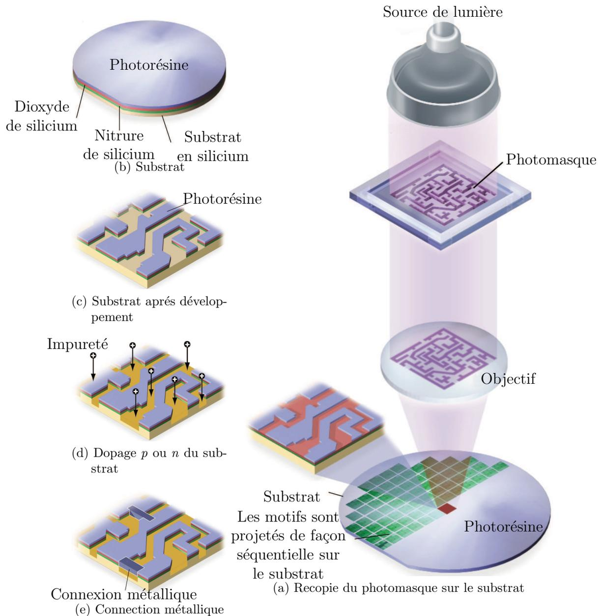
FIGURE 1.1 – Technique de fabrication des semi-conducteurs par la photolithographie classique [2].
