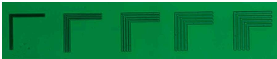
(b) Photo du composant prise à l'aide du microscope optique avec un grandissement  $5x$  en affichant la figure 3.24a sur le SLM.
