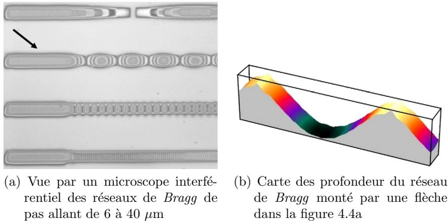
(a) Vue par un microscope interférentiel des réseaux de *Bragg* de pas allant de 6 à 40  $\mu\text{m}$  (b) Carte des profondeurs du réseau de *Bragg* monté par une flèche dans la figure 4.4a
