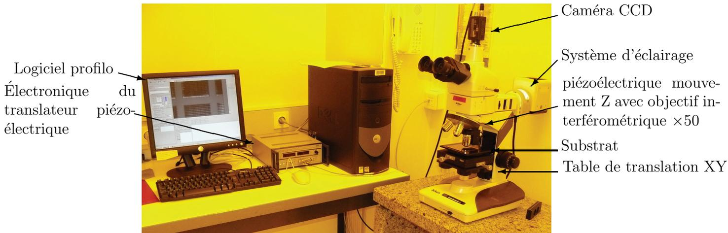
FIGURE B.3 – Photo du microscope interférentiel dans la salle blanche de TÉLÉCOM Bretagne. Le microscope est muni d’objectifs interférométriques de grandissement soit  $\times 10$  soit  $\times 50$  avec un actionneur piézoélectrique en Z. Ce microscope est relié à un ordinateur via une électronique spécifique.
