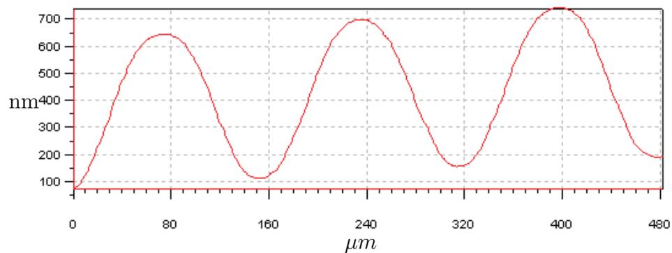
(b) Graphique qui montre les profondeurs de gravure mesurées à l'aide du profilomètre (Annexe B) au niveau de la ligne verte sur la figure 2.14a.
