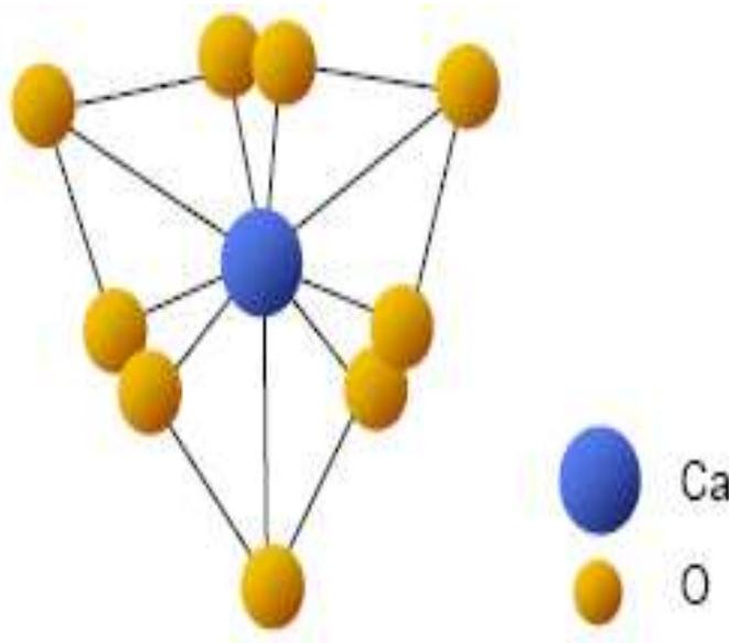
**Figure II.2 :** Environnement des atomes de calcium des sites I dans une fluoroapatite non substituée [7].
