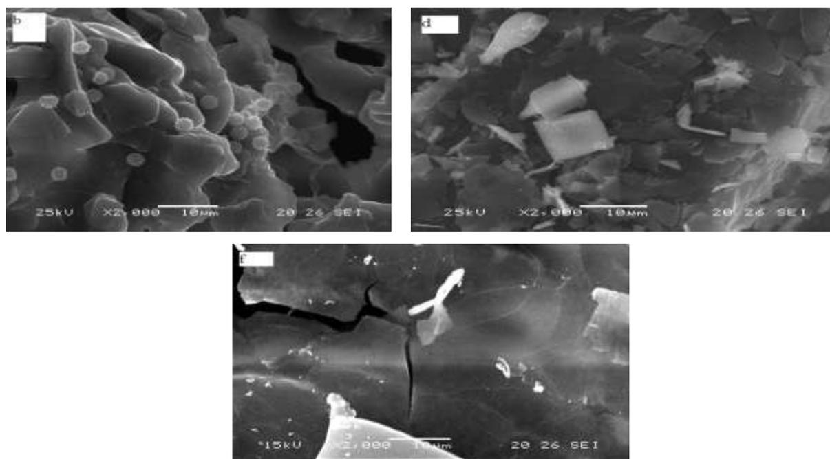
**Figure I.10 :** Clichés de substances humiques observées au **M.E.B.** avec un grossissement de 2000 fois : b) AHC, d) AHS<sub>L</sub>, f) AHS<sub>B</sub>.
