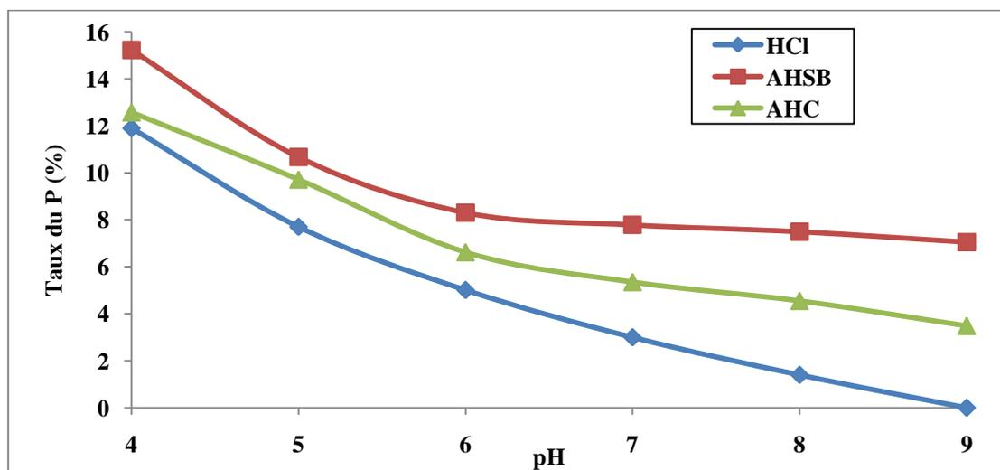
**Figure II. 21 :** Courbes des taux de dissolution du phosphate par les acides humiques (AHC et AHS<sub>B</sub>) et de l'acide chlorhydrique
