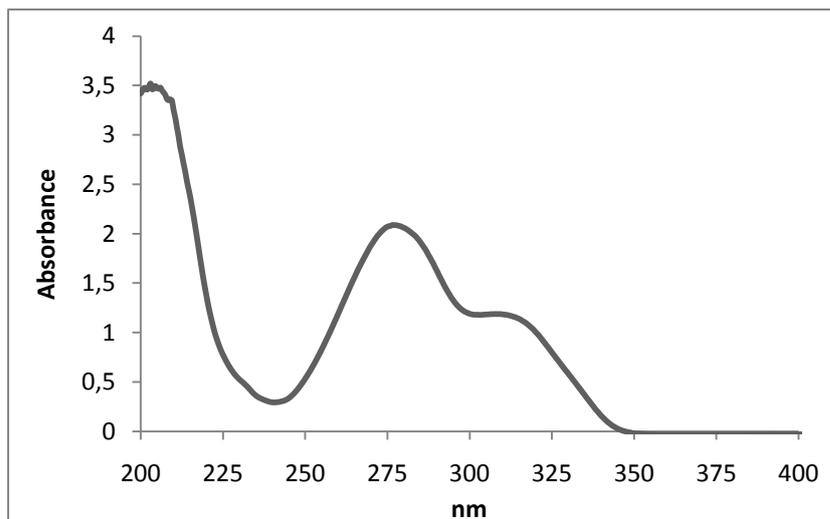
**Figure III.12:** Spectre UV-Visible de la solution de coumarine à  $2,0 \times 10^{-4}$  M.
