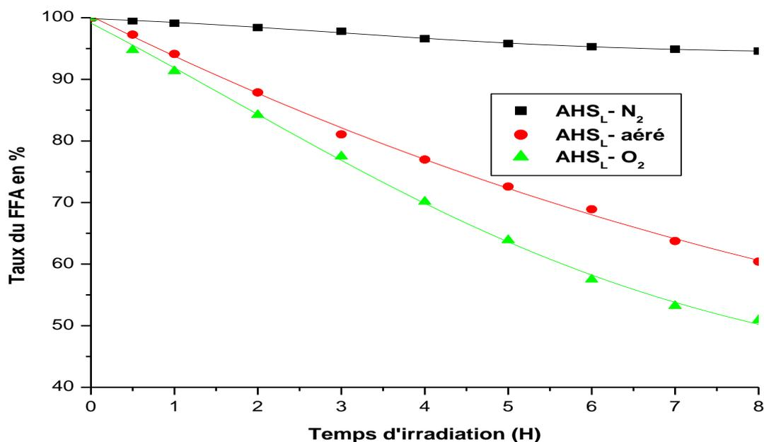
**Figure III.20:** Cinétique de dégradation de l'alcool furfurylique avec AHS<sub>L</sub> dans les milieux aéré, saturé en oxygène et saturé en azote en fonction du temps d'irradiation
