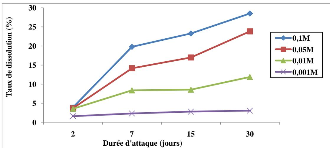
**Figure II.10b :** Taux de P<sub>2</sub>O<sub>5</sub> dissous en fonction de la durée par les solutions d'EDTA
