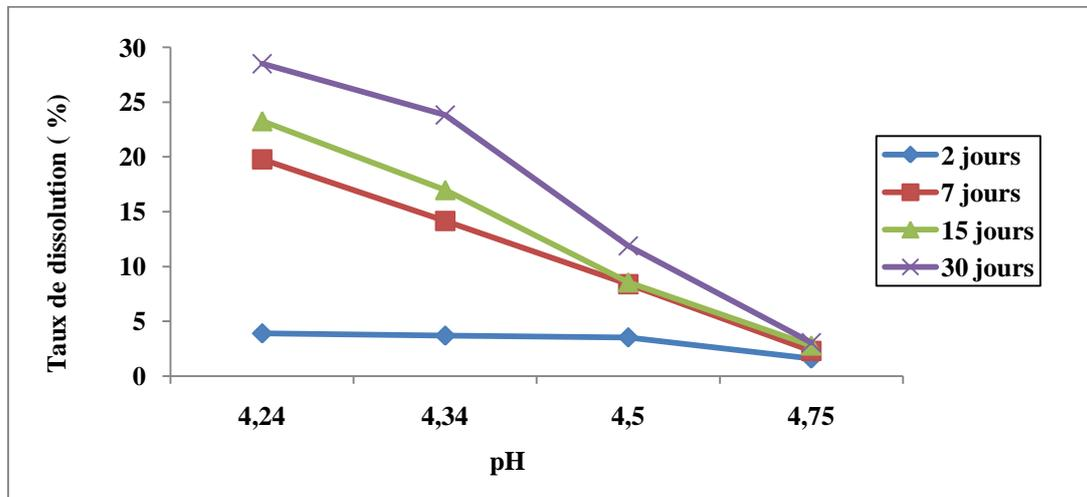
**Figure II.10a :** Taux de P<sub>2</sub>O<sub>5</sub> dissous en fonction du pH par les solutions d'EDTA.
