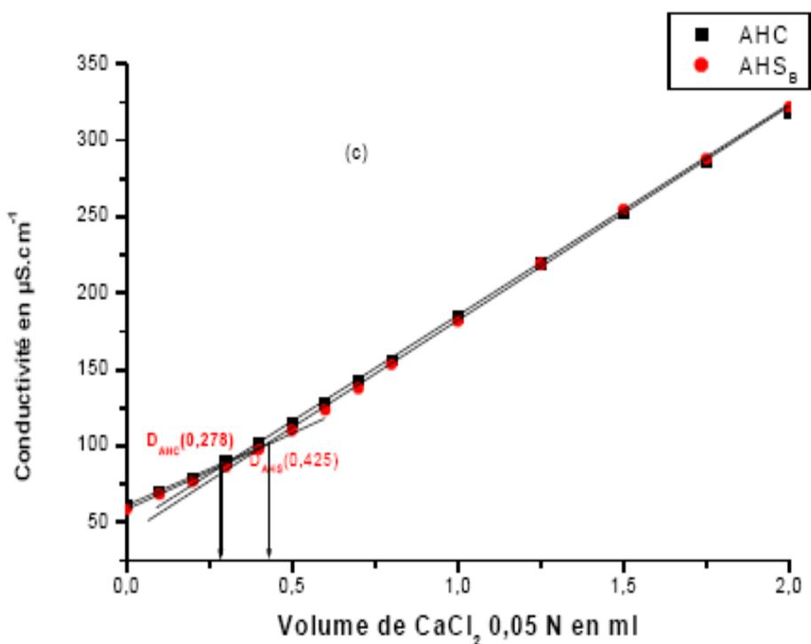
**Figure II.29b:** Etude de la complexation du calcium par les acides humiques ( $\text{AHS}_B$  et AHC) à pH constants (pH =7,10)
