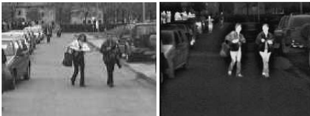
FIG. 2.36 – Exemple typique d’une scène observée dans une caméra opérant dans le visible (à gauche) et dans l’infrarouge (à droite) - figures extraites de [Bertozzi *et al.*, 2007]
