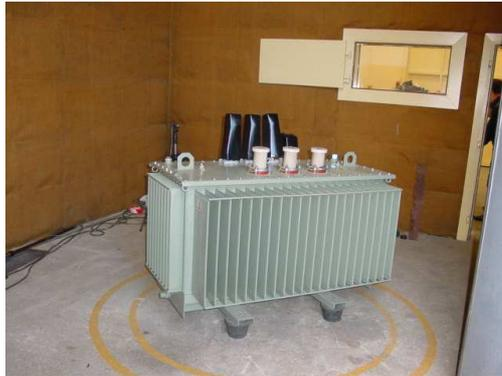
**Figure 63 – Vue d'un appareil en chambre insonorisée**
