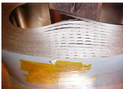
*Figure 59 – Entrefer dans un noyau magnétique amorphe*
