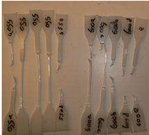
*Figure II.12. Exemple d'éprouvettes après l'essai de fatigue.*
