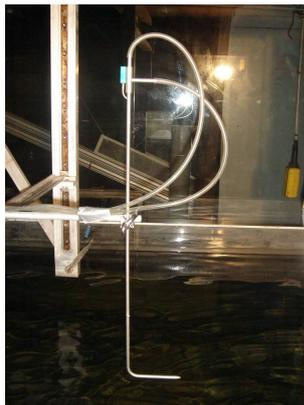
FIG. III.18 – Dispositif du tube de Pitot
