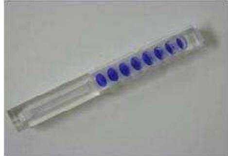
Figure II-10 : (à gauche) photographies de l'Evareader mis à disposition par Evasensor. La flèche indique le compartiment d'introduction de la barrette ; (à droite) barrette en polystyrène comportant 8 puits
