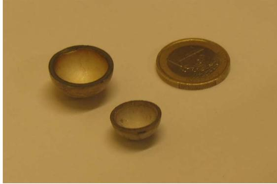
FIGURE 3.1 – Transducteurs piezo-électriques utilisés dans cette thèse ; à gauche : céramique 16/20mm, fréquence de résonance : 1MHz ; à droite : céramique 13/15mm, fréquence de résonance : 2MHz.
