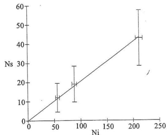
**Figure 3-25:** Diagramme radial et isochrone pour les zircons des tephtras intercalés dans le dépôt de versant de Robledo, vallée d'Aburra.
