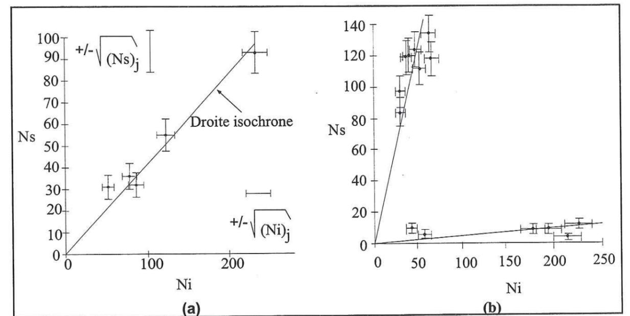
**Figure 2-7 :** Diagramme isochrone. Chaque point représente un cristal daté. Le grain est représenté par son rapport  $(Ns/Ni)_j$ , avec les barres d'erreurs associées. Dans le diagramme de gauche, une seule isochrone; à droite, deux populations distinctes, soit deux isochrones.
