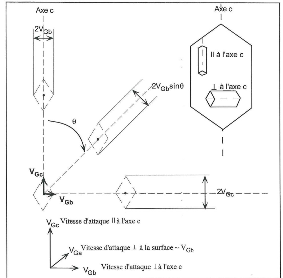
**Figure 2-3 :** Diagramme montrant la forme de la section d'une trace dans le zircon révélée sur un plan parallèle à l'axe cristallographique c, selon l'angle avec l'axe c. (Modifié, d'après Masumoto, 1992).  $\theta$ , angle de la projection d'une trace sur le plan d'observation.
