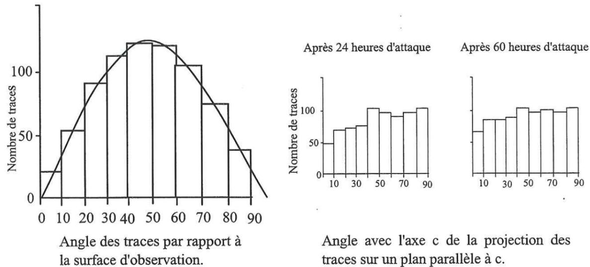
Distribution du nombre de traces selon l'angle d'inclinaison de la trace par rapport à la surface du cristal, d'après Masumoto (1992). L'anisotropie se conserve avec le temps d'attaque.
