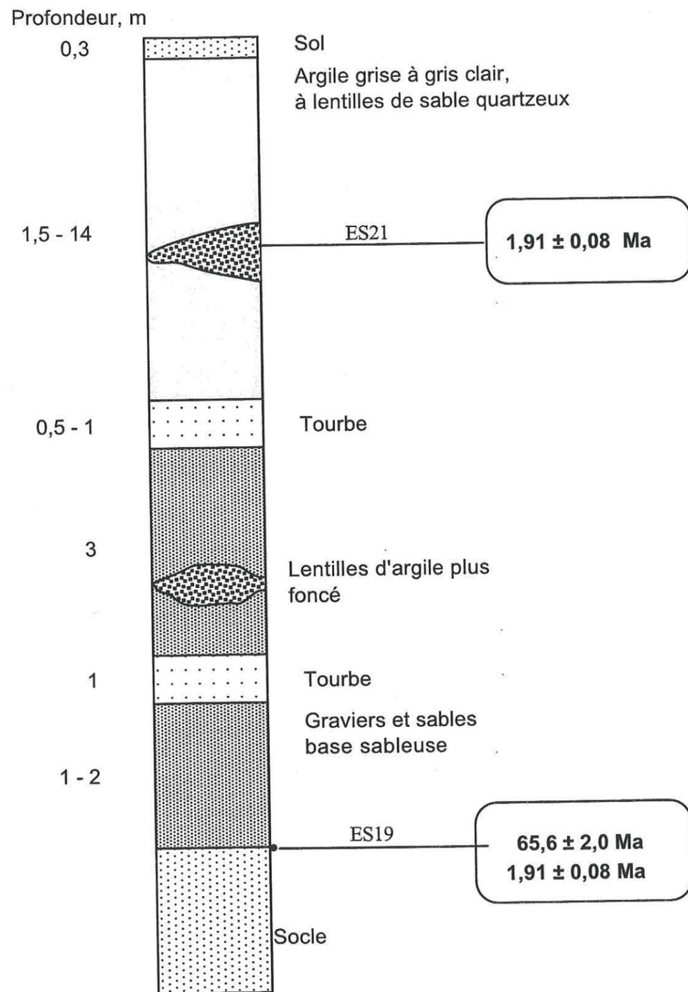
Figure 3-12 : Coupe stratigraphique généralisée des argiles exploitées de la mine La Angela, à Amalfi.
