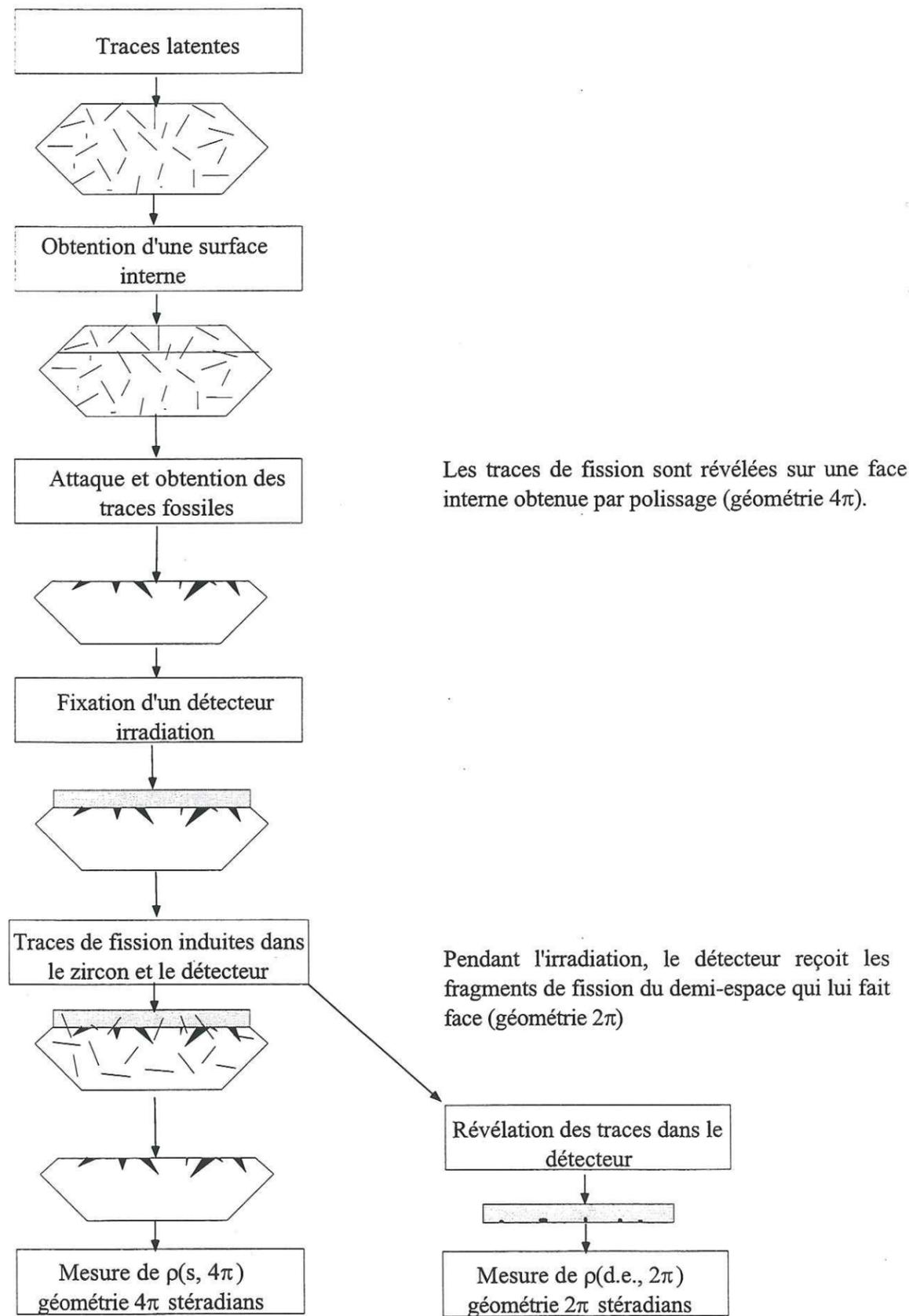
**Figure 2-6 :** Procédure expérimentale pour la datation par détecteur externe. Dans cette technique, les traces révélées dans le zircon proviennent de fissions qui ont eu lieu dans les deux demi-espaces situés de part et d'autre de la surface de polissage (géométrie  $4\pi$  stéradians), alors que celles du détecteur externe ne proviennent plus que d'un demi-espace.
