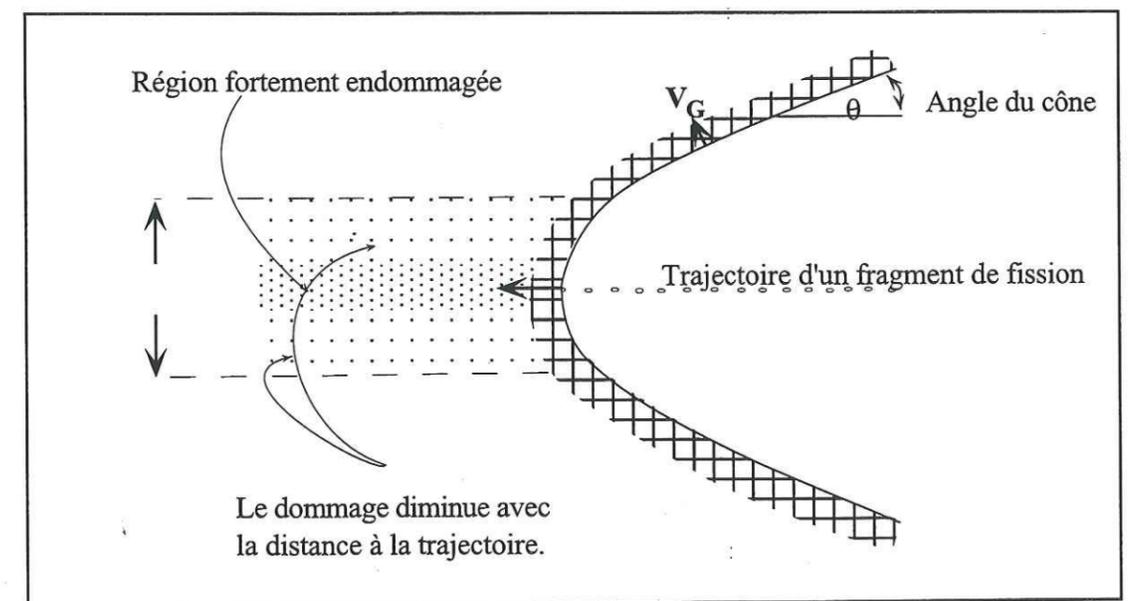
**Figure 2-2 :** Modèle d'attaque d'une trace de fission à l'échelle sub-microscopique. (Modifié d'après Henke et Benton, 1971, in Masumoto, 1992).  $V_G$  et  $V_T$  sont respectivement les taux de dissolution du matériel sain et endommagé par le passage de la particule.
