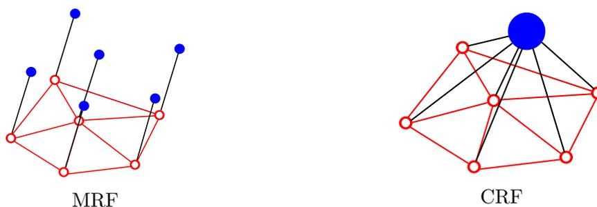
FIGURE 2.9 – MRF et CRF proposés pour l'étiquetage des sommets d'un maillage triangulaire 2-variété : le MRF essaie d'expliquer chaque observation individuellement, tandis que le CRF se sert de toutes les observations pour conditionner le choix des étiquettes des variables cachées.
