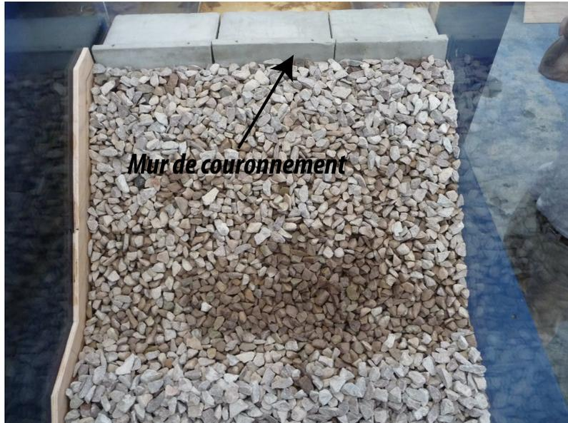
FIG. III.4: Mur de couronnement en béton
