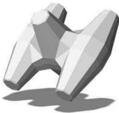
FIG. I.25: Exemple de Core-loc<sup>®</sup> (CLI)
