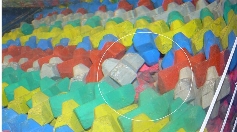
FIG. IV.44: Perte de matériaux de la sous-couche à partir d'une cavité induite par les dommages
