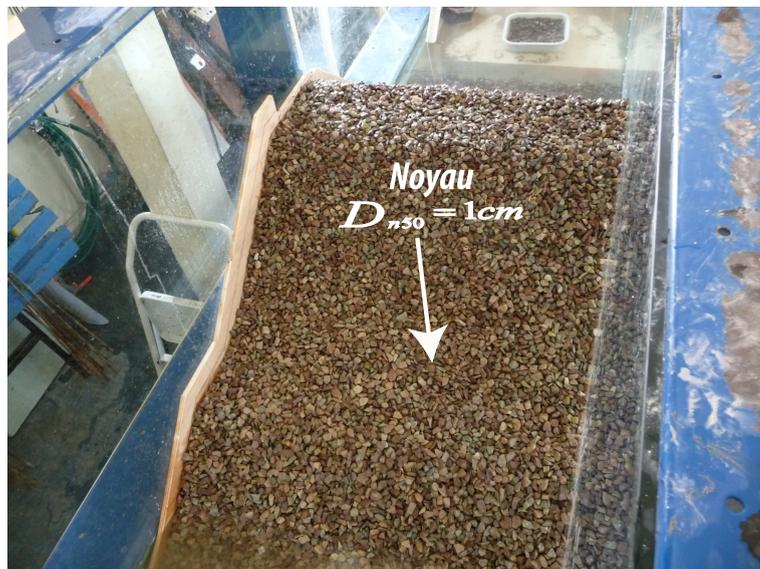
FIG. III.3: Aspect de la sous-couche du modèle
