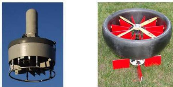
FIG. 1.5 – Le drone iSTAR d'Allied Aerospace (à gauche) et le Polydrone de Polytech'Orléans (à droite)
