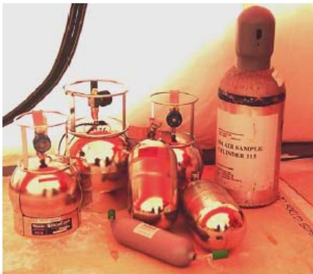
Figure III-5 : Photo des différentes bouteilles de prélèvement utilisées lors de la mission à Berkner Island (Antarctique).
