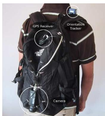
**Figure 4.15. :** *GroundCam* [Di Verdi & Höllerer 07], exemple de systèmes de capture vestimentaires
