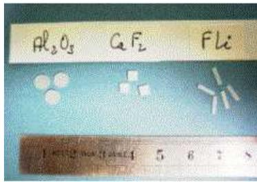
FIG. 7.7 – Types de TLD utilisés
