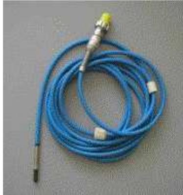
FIG. 7.18 – Chambre d'ionisation gamma
