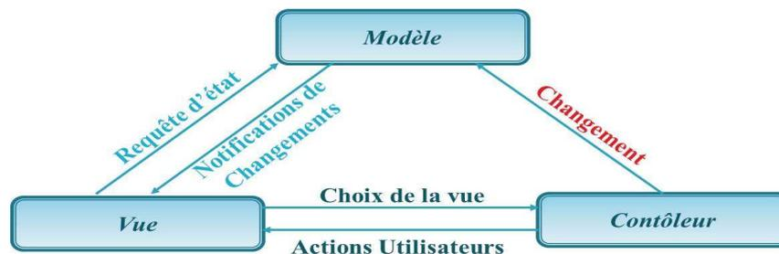
Figure V.14. Interactions entre les couches du modèle MVC
