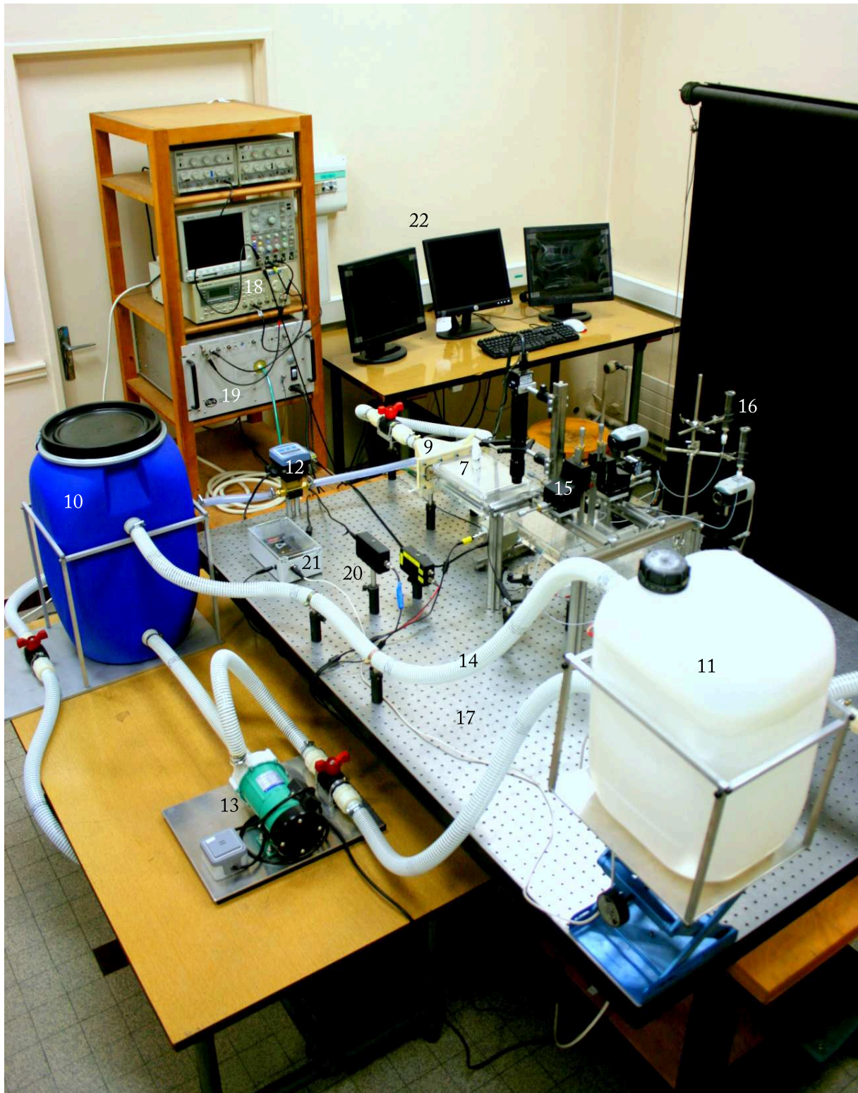
Figure C.9: Photographie du dispositif expérimental “électrocoalescence de deux gouttes dans un écoulement cisailé”: 10, Réservoir aval - 11, Réservoir amont - 12, Débitmètre - 13, Pompe magnétique - 14, Trop-plein - 15, Système de translation XYZ - 16, Réservoir d’eau de 100 ml - 17, Table optique - 18, Générateur de signaux arbitraires - 19, Ampli HT - 20, Sources de lumière LED continue/flash - 21, Système temps-réel de mesure de la température de l’huile - 22, Espace de visualisation
