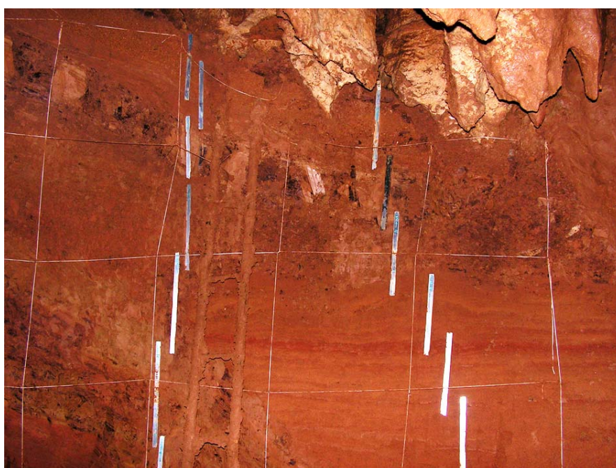
Photo 3 - Exemples d'échantillonnage à l'aide de U-channels ou profilés enfoncés verticalement et perpendiculairement aux unités stratigraphiques dans la grotte du Bois du Clos (chap. 7).
