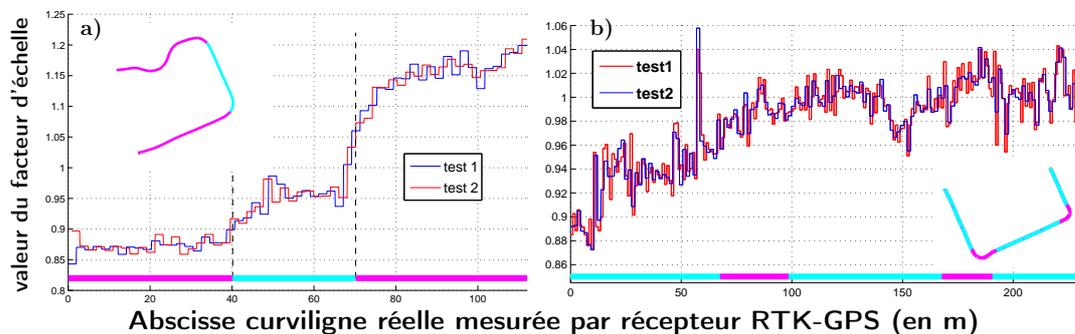
FIG. 4.16 – Estimation hors-ligne des facteurs d'échelle :
