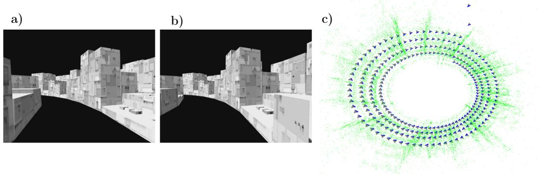
FIG. 3.2 – a) Image  $S_4^{10}$  : la trajectoire de la caméra est déportée de  $4m$  sur la gauche. b) Image  $S_{-4}^{10}$  : la trajectoire de la caméra est déportée de  $4m$  sur la droite. c) Vue de dessus de la reconstruction 3D de la séquence de référence  $S_0$
