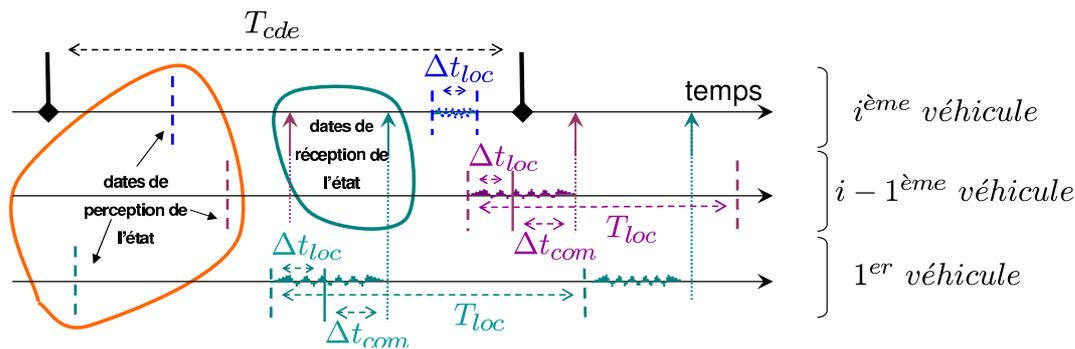
FIG. 4.5 – Acquisition des données pour la commande
