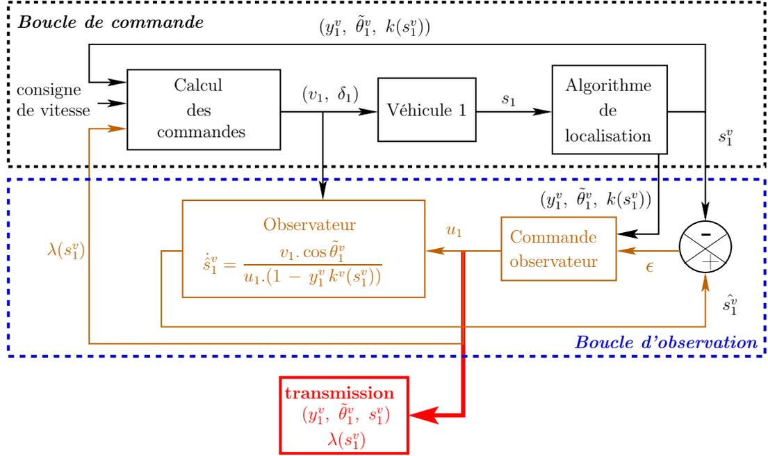
FIG. 3.17 – Schéma d'estimation par observation des corrections
