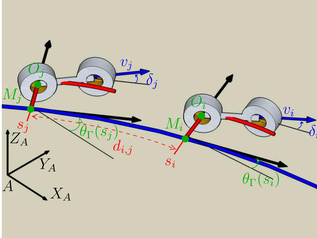
FIG. 1.19 – Ecart longitudinal
