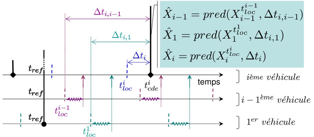
FIG. 4.6 – Recalage temporel des données pour la commande
