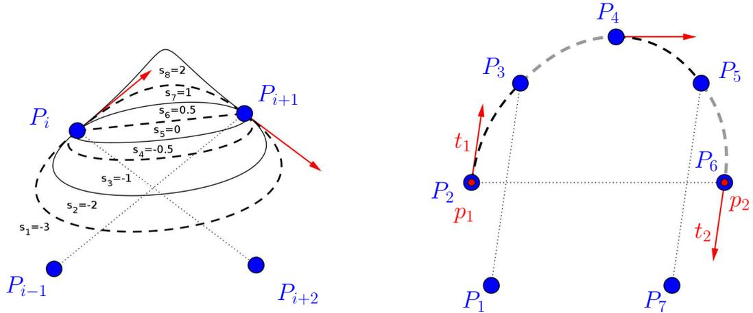
FIG. 2.2 – Exemple d'utilisation des splines définies dans [Eren 99]
