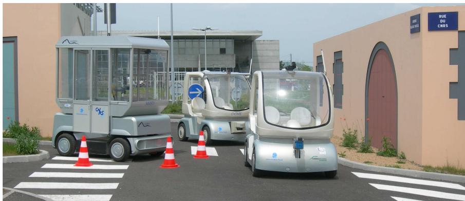
FIG. 4.2 – Les véhicules expérimentaux : deux CyCab et un RobuCab sur PAVIN
