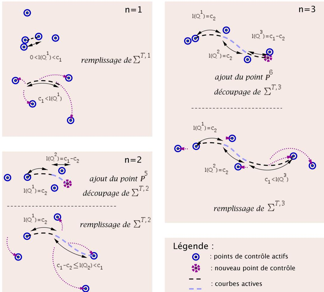
FIG. 2.11 – Extension des B-Spline : phase d'initialisation
