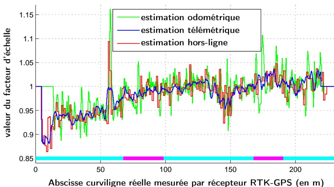
FIG. 4.17 – Estimation en ligne des facteurs d’échelle
