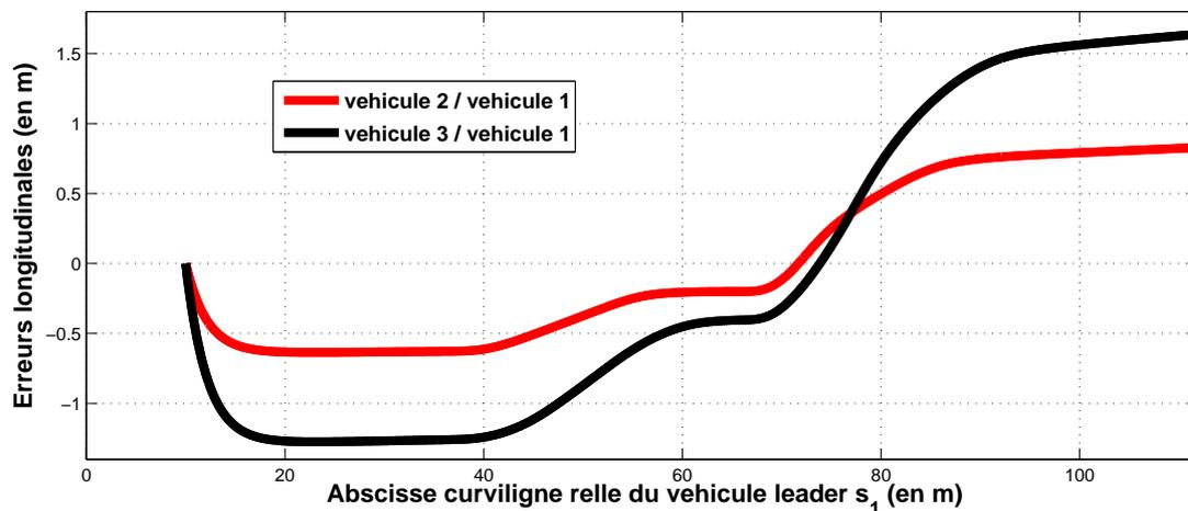
FIG. 3.5 – Performances longitudinales d’un convoi de 3 véhicules
