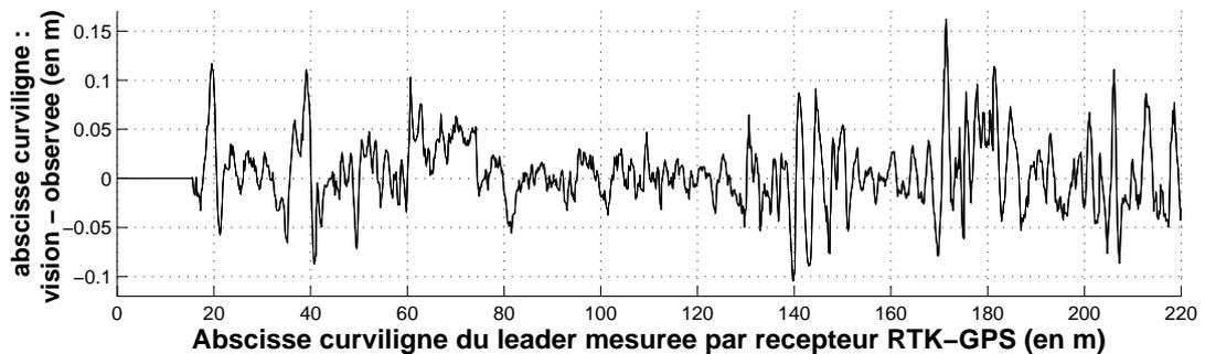
FIG. 4.18 – Erreur d'observation  $\epsilon = s_1^v - \hat{s}_1^v$
