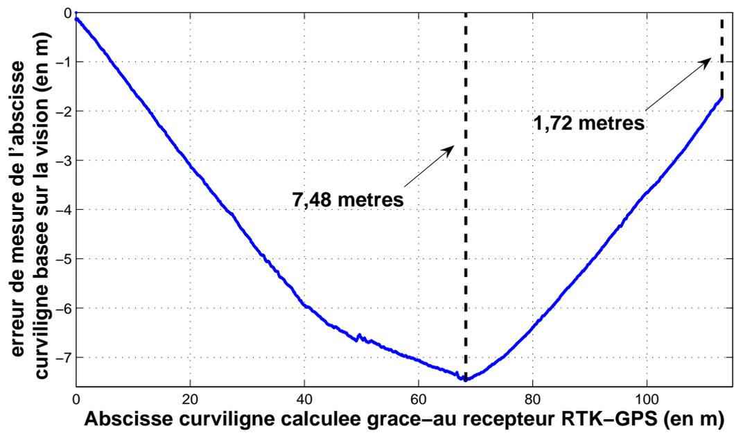
FIG. 1.25 – Erreur d'estimation de l'abscisse curviligne vision par rapport à la réelle
