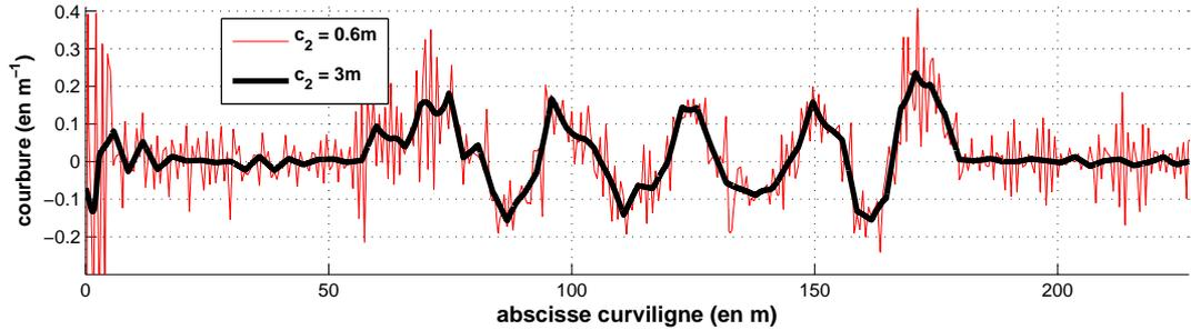
FIG. 2.16 – Effet du bruit sur la courbure en fonction de la valeur de  $c_2$
