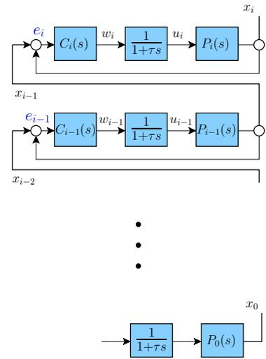
FIG. 1.15 – Modélisation du convoi “référéncé véhicule précédent”
