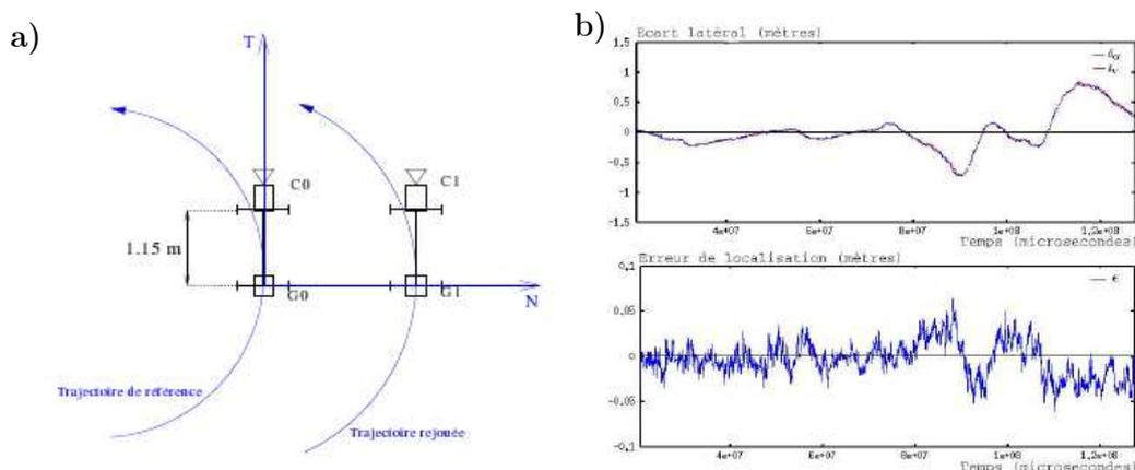
FIG. B.7 – Calcul de l'écart latéral par rapport a la trajectoire de référence a). Erreur latérale (partie b) en haut) mesurée avec le GPS  $y^G$  (bleu) ou par vision  $y^v$  (rouge) et erreur de localisation (partie b) en bas)
