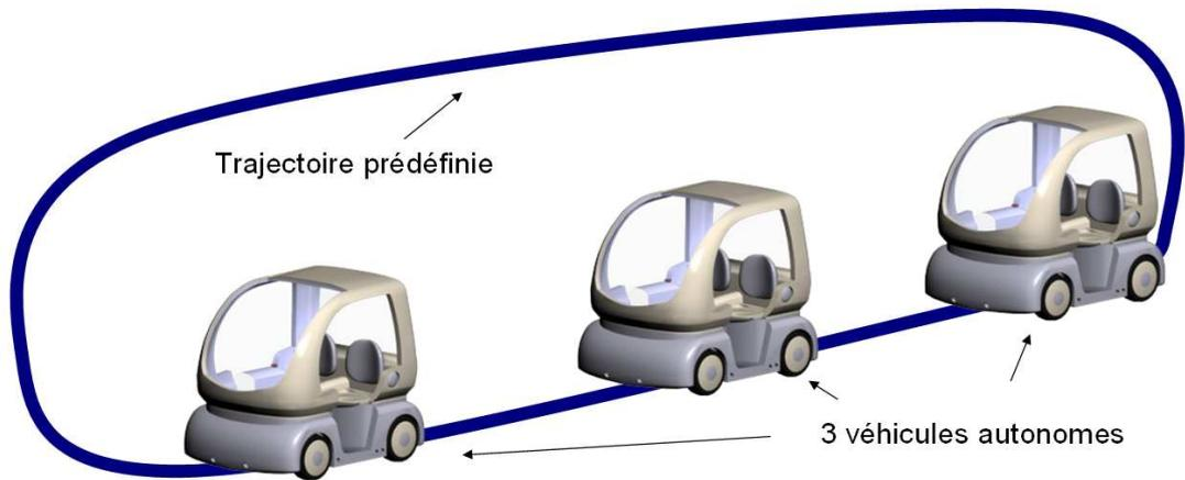
FIG. 2.4 – Exemple de guidage en mode “tout automatique”
