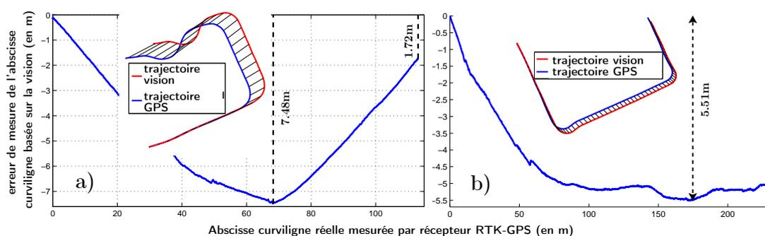
FIG. 4.15 – Trajectoires expérimentales, comparaison avec la vérité terrain :
