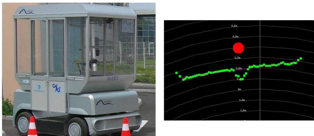
FIG. C.1 – Impacts télémétriques sur l'arrière d'un RobuCab
