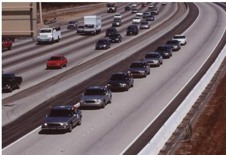
FIG. 1.13 – Convoi de 8 voitures réalisé dans le cadre du projet PATH
