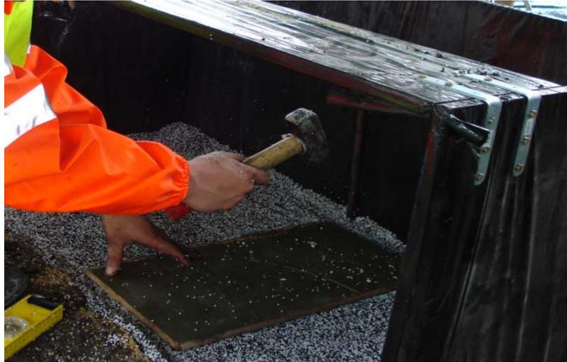
*Figure 94. Deuxième étape de compactage du matériau*
