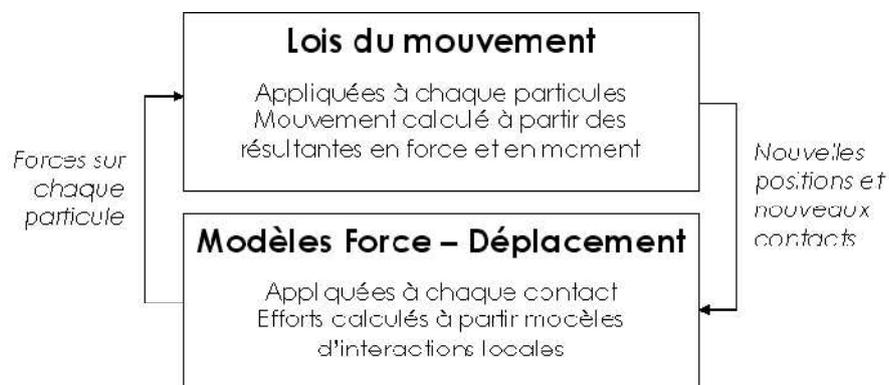
Figure 47 : Cycle de calcul pour une approche MED [BER 06].
