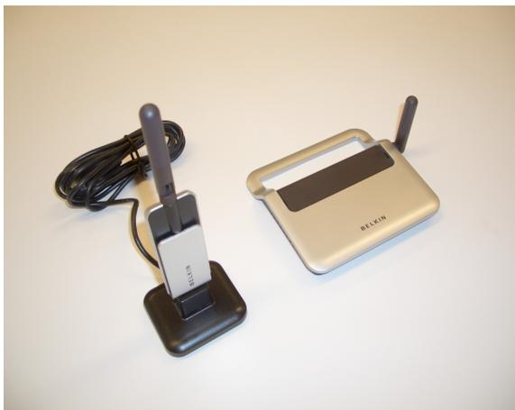
Figure 1.11: Routeur intégrant la technologie ULB de chez BELKIN
