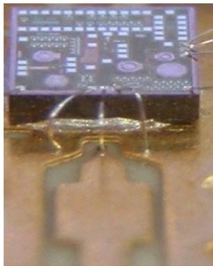
Figure 3.41: La puce et les "wirebonds" réalisés
