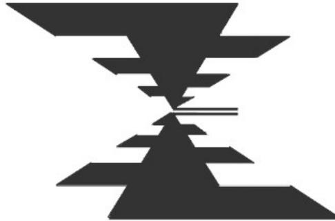
Figure 1.25: Antenne log-périodique trapézoïdale
