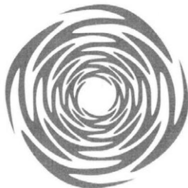
Figure 1.26: Antenne sinueuse
