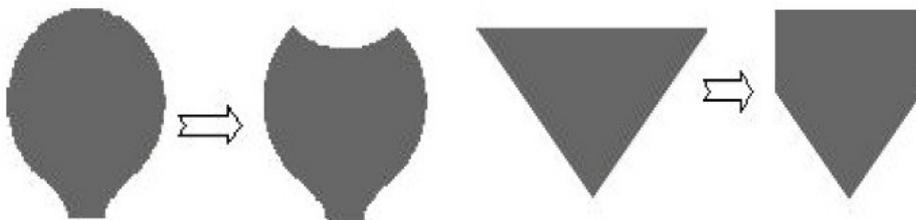
Figure 1.39: Illustration d'exemple de structure rayonnante ayant un périmètre constant pour des géométries différentes
