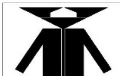
Figure 1.45 Repliement surfacique des plans de masse latéraux vers l'arrière dans le cas d'un monopole imprimé 2D
