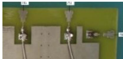
Figure 2.18: Intégration des antennes FCC (R&D) (avec et sans fente) sur PCB
