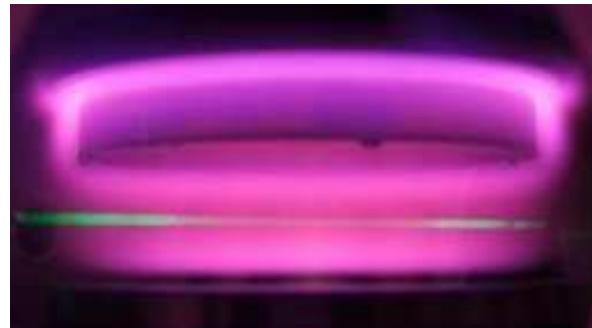
**Figure 11 : Photo d'un plasma  $\text{N}_2\text{-CH}_4$  dans la cavité réactive de PAMPRE ; la trace verte correspond à la diffusion par les poudres en suspension d'un laser vert à 532 nm.**
