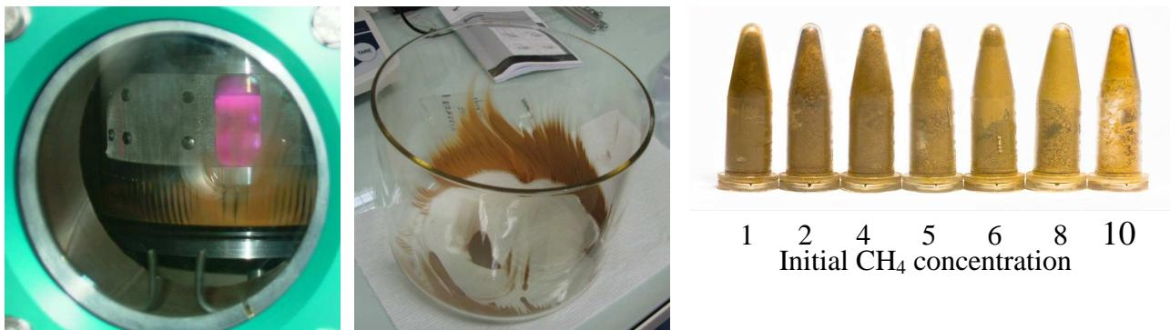
**Figure 13 : Photo du dépôt et de la récolte de poudres dans le cristallisoir au bout de quelques heures d'expérience en plasma continu d'azote-méthane.**
