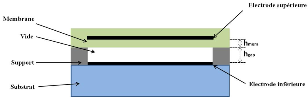
Figure 2.1 Schéma d'une cellule élémentaire de cMUT
