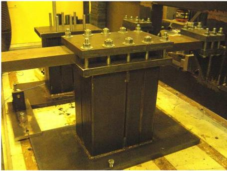
FIGURE 7.2 – Encastrement du système
