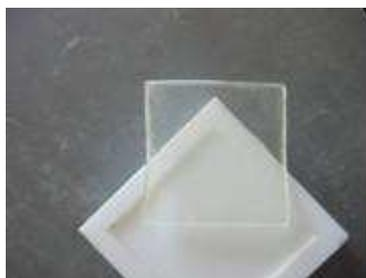
**Figure 3** Film de polyuréthane irradié sous UV pendant 60 min
