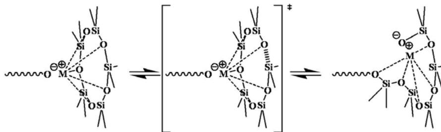
**Figure 15: Schéma de l'interaction multicentre entre le contre ion métallique  $M^+$  du centre actif et le monomère ou la chaîne siloxane porteuse du centre actif qui permet d'expliquer les interactions en faveur de la réaction de « back biting »**
