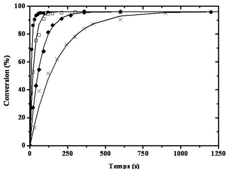
Figure 9: Conversion du monomère en fonction du temps de réaction lors de la polymérisation en masse du D5 ( $2,58 \text{ mol.L}^{-1}$ ) catalysée par la base  $\text{P}_4^t\text{Bu}$  ( $1,75 \cdot 10^{-4} \text{ mol.L}^{-1}$ ) pour différentes températures : × :  $90^\circ\text{C}$ , ♦ :  $100^\circ\text{C}$ , □ :  $110^\circ\text{C}$ , ● :  $120^\circ\text{C}$
