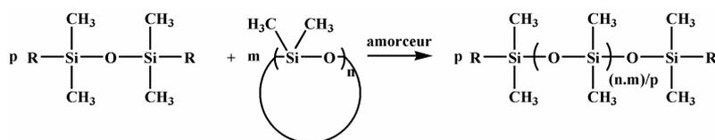
**Figure 5: Contrôle de la longueur de chaîne par utilisation d'agents bloquants lors de la ROP**
