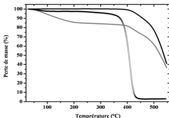
Figure 15: Analyse thermogravimétrique : ○ – copolymère de départ (25 000 g.mol<sup>-1</sup>, 2,8%<sub>w</sub> PDMS) ;
