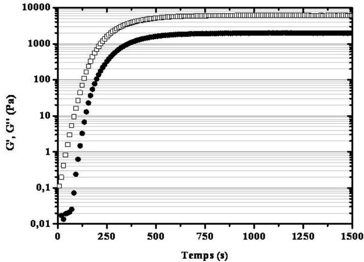
Figure 18: Evolution caractéristique des modules viscoélastiques  $G'$  (●) et  $G''$  (□) en fonction du temps de la réaction de polymérisation ( $T=90^{\circ}\text{C}$ ,  $\text{P}_4^t\text{Bu}$  à  $1,75 \cdot 10^{-4} \text{ mol.L}^{-1}$ )
