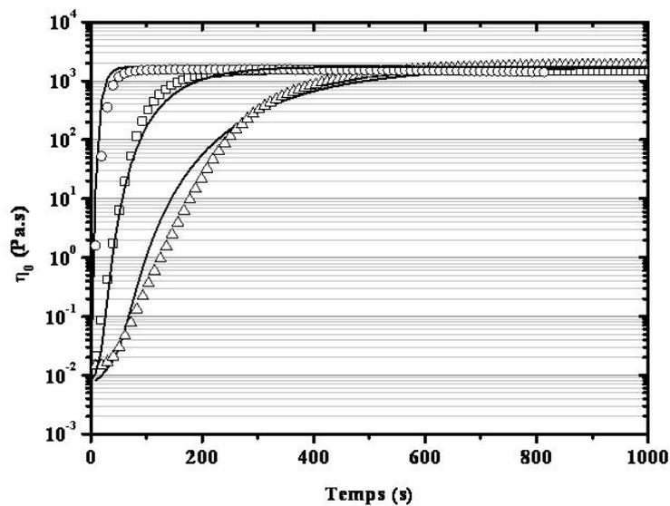
Figure 21: Tracé de la viscosité en fonction du temps pour la base P<sub>4</sub><sup>t</sup>Bu à différentes températures. Visualisation du modèle en ligne pleine. Δ : 90°C, □ : 100°C, ○ : 120°C
