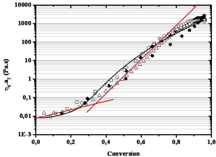
Figure 20: Courbe exposant la variation de viscosité en fonction de la conversion pour différentes températures et catalyseurs. P<sub>4</sub><sup>t</sup>Bu - Δ : 90°C, □ : 100°C, ● : 110°C et P<sub>4</sub><sup>t</sup>Oct - ○ : 110°C, ◆ : 120°C
