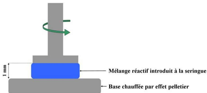
**Figure 6: Réacteur constitué par l'entrefer d'un rhéomètre**
