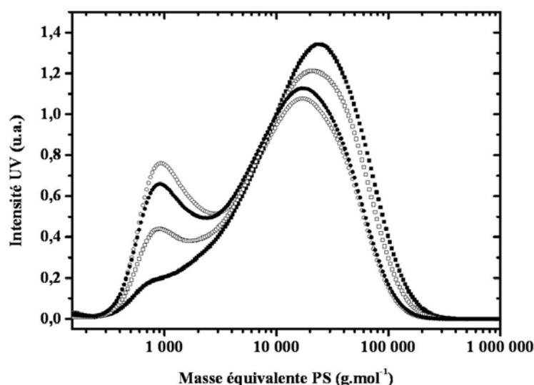
**Figure 12: Chromatogramme du suivi par CES de la polymérisation en présence du limiteur de chaîne modèle pour 10 min (○), 20 min (●), 2 h (□), 15h30 (■)**
