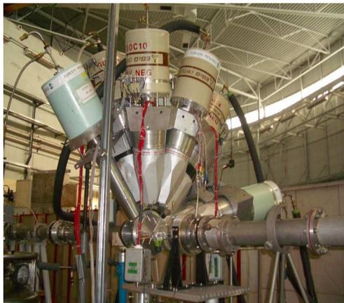
FIGURE 5.3 – Dispositif de détection des photons  $\gamma$ .
