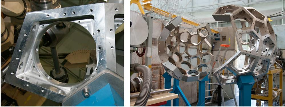
**FIGURE 2.17** – A gauche, une alvéole composant la structure de la sphère ORGAM. A droite, le support d'ORGAM avant l'installation des détecteurs.
