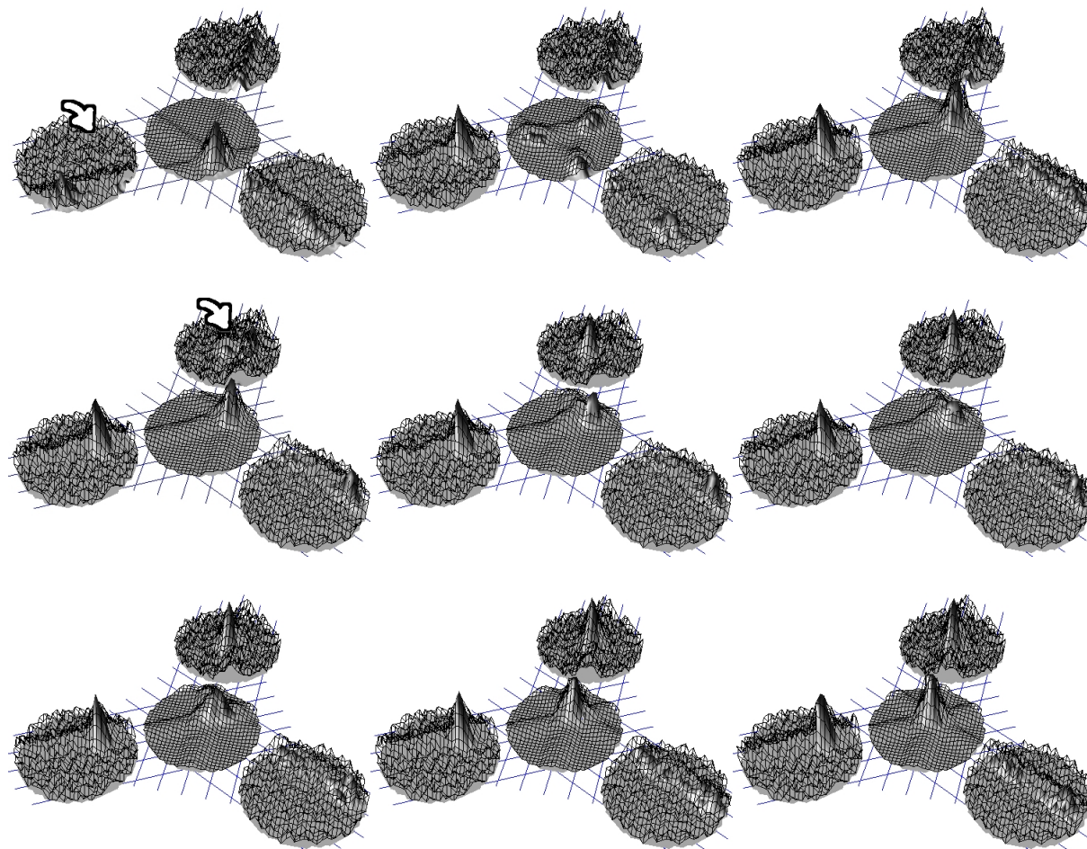
FIGURE 4.15 – Dynamique de restitution de cohérence dans le modèle bi_jama . Le module central est le module associatif. La surface pleine grise correspond au potentiel de sortie A^* (copie du potentiel #4 pour les modules primaires, du potentiel #5 pour le module associatif, cf. figure 4.13). Les surfaces « en grille » sont le potentiel jouant le rôle d'entrée dans la compétition (potentiel #3 pour les modules primaires, #4 pour le module associatif). Dans le sens de lecture : la première image représente un état stabilisé en l'absence d'entrées. On impose alors au système une entrée, maintenue, sur un des modules, de sorte qu'une zone localisée réponde par une activation corticale (potentiel #1) à un endroit précis, marqué d'une flèche sur la première image. Les images 2 et 3 montrent l'évolution de l'ensemble du système, qui se stabilise dans un nouvel état cohérent. Dans un autre module, on impose alors une entrée localisée et maintenue, comme précédemment, à l'endroit marqué d'une flèche sur la quatrième image. Les images suivantes montrent les étapes qui conduisent à la nouvelle stabilisation du système. On notera, au cours de cette stabilisation, le glissement de la bulle dans le module associatif, et le glissement du profil de potentiels dans le module de droite.
