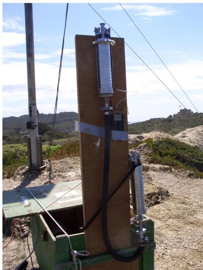
FIGURE .2.4 – Les deux impacteurs en cascade
