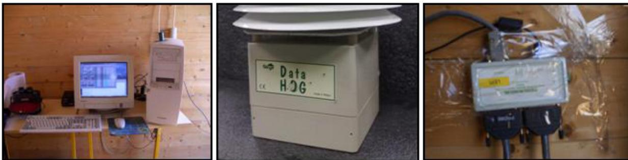
FIGURE 2.6 – Appareils d’acquisitions des données météorologiques et granulométriques : Le PC, le DataHog, le DA001
