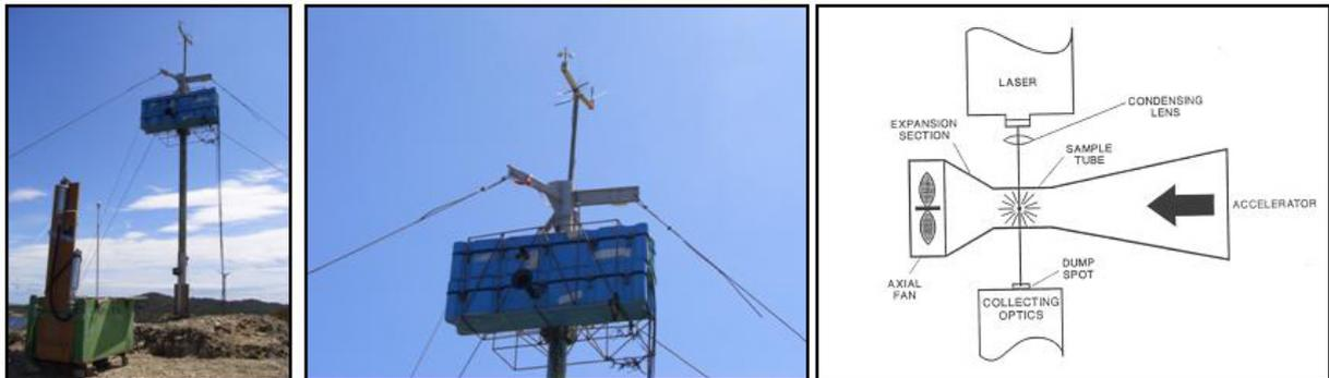
FIGURE .2.5 – Les deux sondes granulométriques montées et le schéma de fonctionnement
