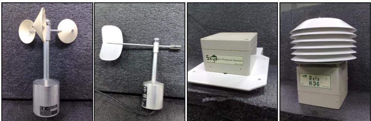
FIGURE .2.3 – Capteurs météorologiques ; De gauche à droite : l’anémomètre, la girouette, le baromètre, le thermomètre/hygromètre
