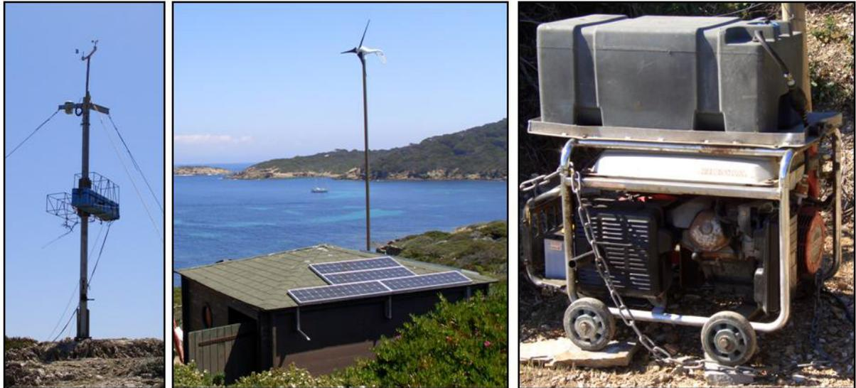
FIGURE .2.2 – Station de mesure de Porquerolles. De gauche à droite : le mât météorologique et porteur des granulomètres, l’abri avec les panneaux solaires et son éolienne, le groupe électrogène.
