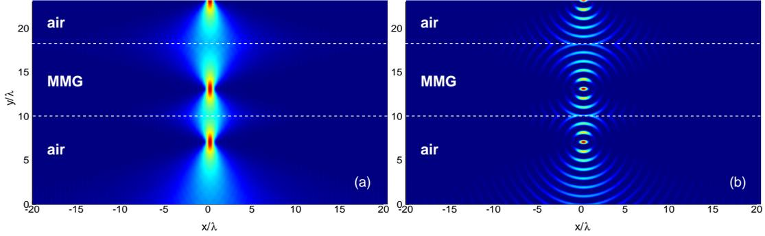
FIGURE 2.3 – Focalisation d'un faisceau par une couche de milieu main-gauche d'indice  $-1$ . Aucune réflexion n'a lieu car les permittivités et les perméabilités de l'air et du MMG sont opposées. (a) Module du champ. (b) Partie réelle du champ.
