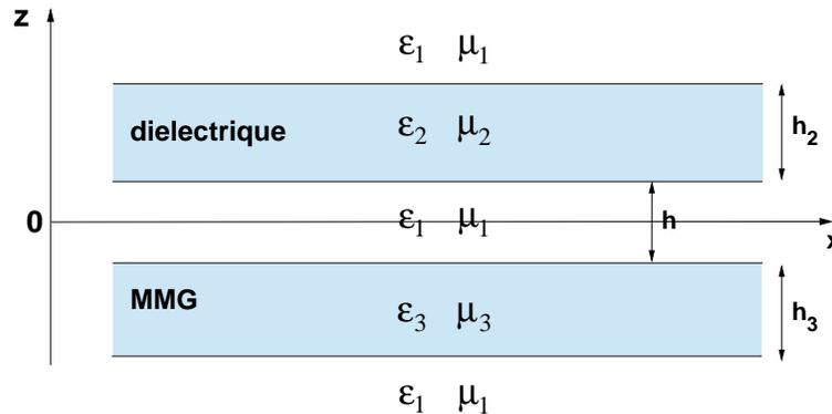
FIGURE 3.1 – Les deux guides d'ondes sont séparés d'une distance  $h$  et plongés dans un milieu caractérisé par  $\epsilon_1$  et  $\mu_1$ .
