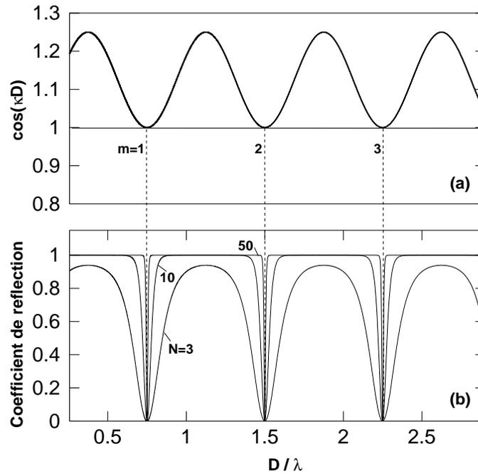
FIGURE 4.1 – (a)  $\cos(\kappa D)$ , donné par la relation de dispersion (4.1) et (b) coefficient de réflexion d'un cristal photonique de dimension finie, en fonction de la fréquence réduite  $D/\lambda$ . Le cristal photonique de période  $D$  est composé de deux milieux caractérisés par  $n_1 = 1$ ,  $n_2 = -2$  et  $d_2 = 2d_1$ . Différents nombres de périodes sont considérés,  $N = 3, 10, 50$ .
