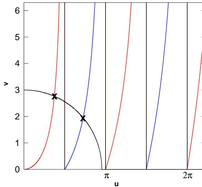
FIGURE 1.6 – Relations de dispersion symétrique (courbe rouge) et antisymétrique (courbe bleue) tracées dans le plan  $(u, v)$ . Les points d'intersections avec le cercle noir d'équation (1.76) correspondent aux modes guidés supportés par le guide.
