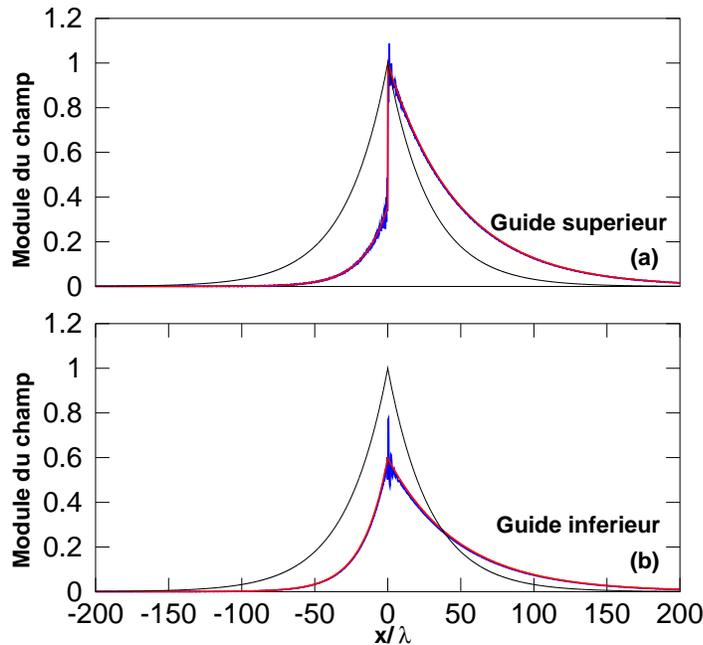
FIGURE 3.13 – *Module du champ au centre (a) du guide diélectrique, et (b) du guide gauche. Les courbes bleues sont obtenues par simulation et les courbes rouges sont données par le modèle (3.16). Courbes noires : cas non dissipatif (3.9).*
