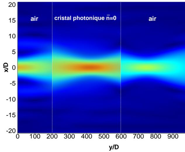
FIGURE 4.11 – *Module du champ électromagnétique lorsqu'un cristal photonique d'indice moyen nul, mais de moyenne harmonique de son indice  $\langle \frac{1}{n} \rangle$  vaut  $-1$ , entouré par de l'air ( $n_0 = 1$ ), est éclairé par un faisceau. Les paramètres sont :  $N = 400$ ,  $d_1 = D/3$ ,  $d_2 = 2D/3$ ,  $n_1 = 1$ ,  $n_2^0 = -0.5$ ,  $\eta_1 = 1$ ,  $\eta_2 = 0.5$ ,  $D = 3\lambda_0$  et  $C = 0.48/\lambda_0$ .*
