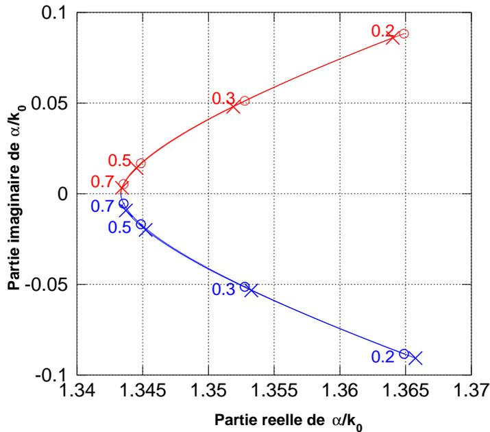
FIGURE 3.12 – Solutions de la relation de dispersion (3.2), dans le plan complexe de la constante de propagation  $\alpha$ , pour différentes valeurs de  $h$  en longueur d'onde, la distance séparant les guides couplés.
