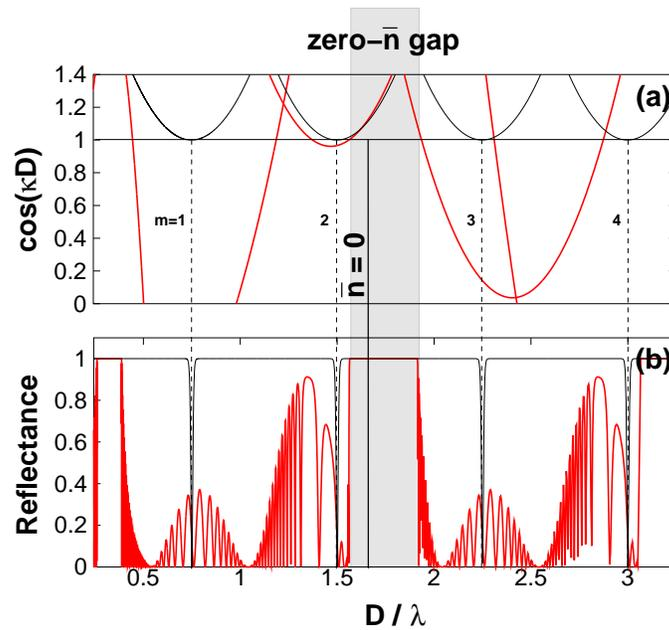
FIGURE 4.5 – (a) Développements limités de la relation de dispersion donnés par l'équation (4.12), pour  $m=1,2,3,4$ . (b) Coefficient réflexion d'une structure formée de 50 périodes. Les paramètres de la structure sont les mêmes que sur la figure 4.4, mais  $C = 1/\lambda_0$ . Courbes noires : aucun matériau n'est dispersif. Courbes rouges : le métamatériau main-gauche est dispersif.
