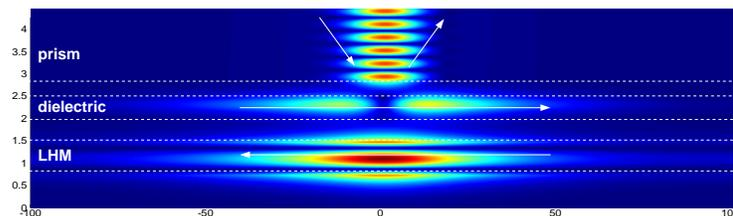
FIGURE 3.3 – Boucle de lumière excitée par un faisceau gaussien (angle d'incidence :  $36.9^\circ$ , waist :  $10\lambda$ ) incident dans un prisme ( $\varepsilon = 5$ ,  $\mu = 1$ ). La distance séparant le guide de la surface du milieu main-gauche est  $h = 0.7\lambda$ .
