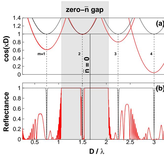
FIGURE 4.4 – (a) Développements limités de la relation de dispersion donnés par l'équation (4.12), pour  $m=1,2,3,4$ . (b) Coefficient réflexion d'une structure formée de 50 périodes. Les paramètres de la structure sont :  $n_1 = 1$ ,  $n_2^0 = -2$ ,  $\eta_1 = 1$ ,  $\eta_2 = 0.5$ ,  $d_1 = 2D/3$ ,  $d_2 = D/3$ ,  $D/\lambda_0 = 13/8$  et  $C = 0.5/\lambda_0$ . Courbes noires : aucun matériau n'est dispersif. Courbes rouges : le métamatériau main-gauche est dispersif (4.7).
