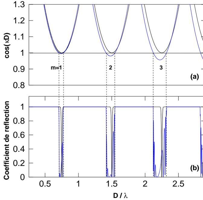
FIGURE 4.3 – (a) Développement limité de  $\cos(\kappa D)$ , donné par l'équation (4.12) pour  $m = 1, 2, 3$ . (b) Coefficient de réflexion de la structure décrite à la figure 4.1 mais avec  $n_2 = n_2^0 + \Delta n_2$  où  $n_2^0 = -2$ . Courbes noires :  $\Delta n_2 = 0$ , courbes bleues :  $\Delta n_2 = 0.06$ .
