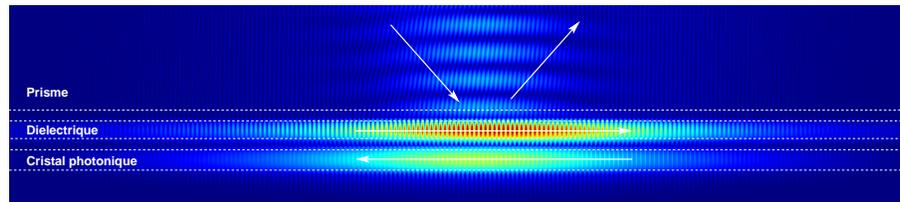
FIGURE 3.33 – *Boucle de lumière excitée par couplage évanescent par un faisceau incident (angle d'incidence :  $47^\circ$ , waist :  $5\lambda$ ) dans un prisme ( $\varepsilon = 9$ ,  $\mu = 1$ ). Le guide supérieur, constitué d'un milieu diélectrique ( $\varepsilon = 7.29$ ,  $\mu = 1$ ,  $h_1 = 0.3\lambda$ ), et le guide inférieur, constitué par un cristal photonique, sont séparés d'une distance  $h_1 = 0.05\lambda$  et entourés par de l'air ( $\varepsilon = 1$ ,  $\mu = 1$ ).*
