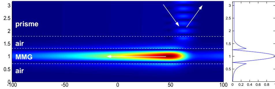
FIGURE 2.6 – Mode guidé pair d’une couche de milieu main-gauche ( $\epsilon_2 = -1, \mu_2 = -3$ ) entourée d’air, excité par couplage évanescent. Sa constante de propagation est  $\alpha_2 = 1.410k_0$ . Le mode, très localisé dans le milieu main-gauche, est contra-propagatif.
