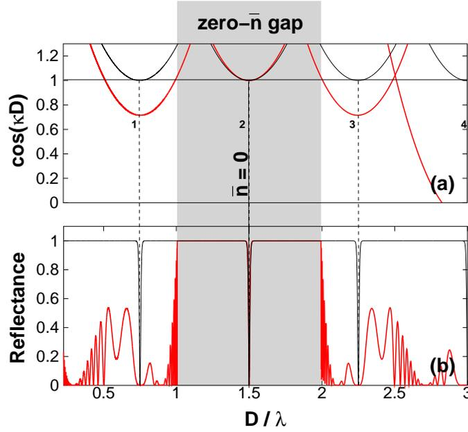
FIGURE 4.7 – (a) Développements limités de la relation de dispersion donnés par l'équation 4.12, pour  $m=1,2,3,4$ . (b) Coefficient réflexion d'une structure formée de 50 périodes. Les paramètres de la structure sont les mêmes que sur la figure 4.4, mais  $D = 1.5\lambda_0$ . Courbes noires : aucun matériau n'est dispersif. Courbes rouges : le métamatériau main-gauche est dispersif.
