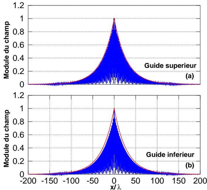
FIGURE 3.8 – *Module du champ au centre (a) du guide diélectrique, et (b) du guide gaucher. Les courbes bleues sont obtenues d’après la simulation (figure 3.7) et les courbes rouges sont données par le modèle (3.9).*
