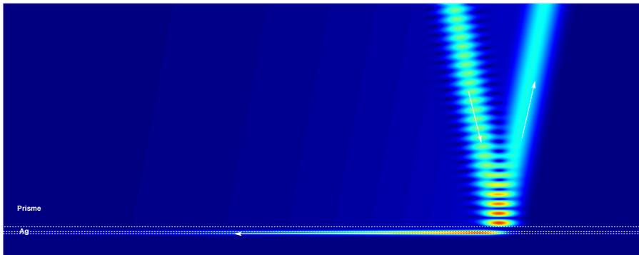
FIGURE 3.25 – Mode contra-propagatif dans une couche d'argent, excitée par couplage évanescent par un faisceau incident (angle d'incidence :  $70.3^\circ$ , waist :  $5\lambda$ ) dans un prisme de rutile ( $\varepsilon = 49$ ,  $\mu = 1$ ). Le film d'argent est caractérisé par sa permittivité à  $420\text{nm}$   $\varepsilon = -4.4$  et son épaisseur  $h_1 = 0.041\lambda$ . Il est plongé dans du niobate de lithium ( $\varepsilon = 5.5$  et  $\mu = 1$ ).
