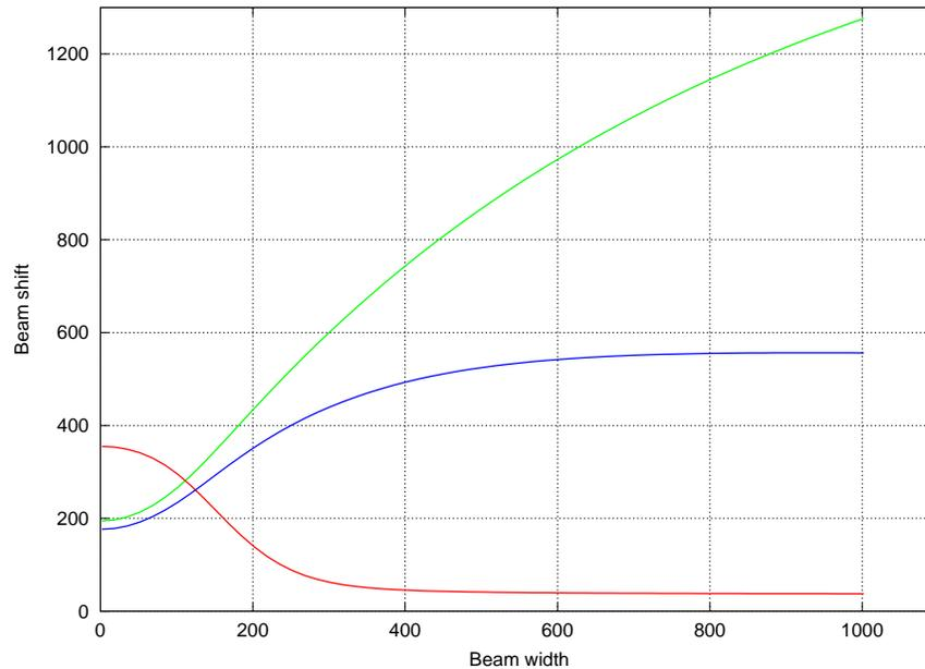
FIGURE 1.11 – Décalage latéral  $\Delta$  en fonction de la largeur du faisceau incident (quatre fois le waist). (i) courbe bleue : décalage latéral associé à l'excitation d'un mode guidé pour un seul guide, (ii) courbe verte : deux guides couplés avec un angle d'incidence de  $33.85^\circ$ , et (iii) courbe rouge : deux guides couplés, avec un angle d'incidence de  $33.9^\circ$ .
