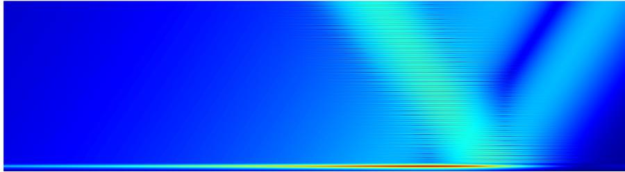
FIGURE 3.14 – Mode de surface contra-propagatif excité à l'interface d'un milieu main-gauche ( $\varepsilon_3 = -0.8$ ,  $\mu_3 = -1.5$ ) et de l'air, par un faisceau incident (angle :  $33.9^\circ$ , waist :  $10\lambda$ ) dans un prisme ( $\varepsilon = 5$ ,  $\mu = 1$ ).
