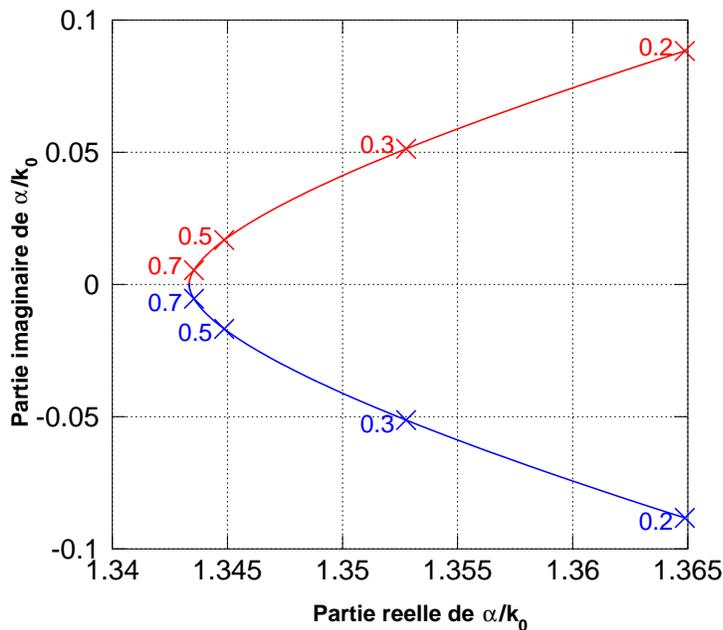
FIGURE 3.2 – Solutions de la relation de dispersion (3.2), dans le plan complexe de la constante de propagation  $\alpha$ , pour différentes valeurs de la distance  $h$  séparant les guides couplés, en unité de longueur d'onde ( $h = 0.2, 0.3, 0.5, 0.7$ ).
