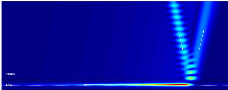
FIGURE 3.27 – Mode de film fin contra-propagatif excité par couplage évanescent par un faisceau incident (angle d’incidence :  $64.6^\circ$ , waist :  $5\lambda$ ) dans un prisme ( $\epsilon = 5$ ,  $\mu = 1$ ). Le MEN est caractérisé par  $\epsilon = -0.5$ ,  $\mu = 1$ ,  $h_1 = 0.057\lambda$  et le milieu extérieur par  $\epsilon = 1.1$  et  $\mu = 1$ .
