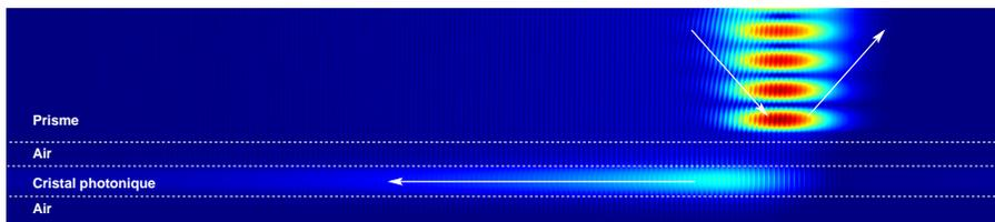
FIGURE 3.31 – Mode guidé contra-propagatif dans une couche de cristal photonique, excitée par couplage évanescent par un faisceau incident (angle d'incidence :  $47^\circ$ , waist :  $5\lambda$ ) dans un prisme ( $\varepsilon = 9$ ,  $\mu = 1$ ).
