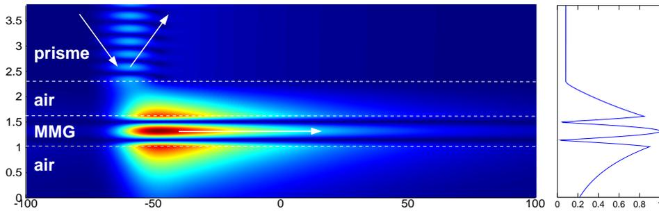
FIGURE 2.5 – Mode guidé pair d'une couche de milieu main-gauche ( $\varepsilon_2 = -1, \mu_2 = -3$ ) entourée d'air, excité par couplage évanescent. Sa constante de propagation est  $\alpha_1 = 1.035k_0$ . Le mode, peu localisé dans le milieu main-gauche, n'est pas contra-propagatif.
