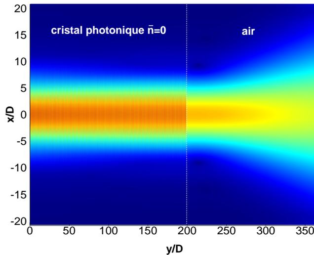
FIGURE 4.9 – *Module du champ électromagnétique lorsqu’un cristal photonique d’indice moyen nul, suivi par de l’air ( $n_0 = 1$ ), est éclairé par un faisceau. Les paramètres de la structure sont  $N = 200$ ,  $d_1 = d_2 = D/2$ ,  $n_1 = 2$ ,  $n_2^0 = -2$ ,  $\eta_1 = 1$ ,  $\eta_2 = 0.5$ ,  $D = \lambda_0$  et  $C = 0.48/\lambda_0$ .*
