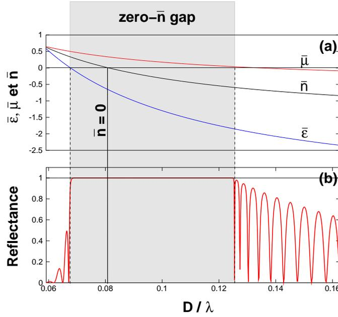
FIGURE 4.2 – (a) Paramètres constitutifs moyens du cristal photonique. (b) Coefficient de réflexion d'une structure comptant 50 périodes. Les paramètres du cristal photonique sont :  $n_1 = 1$ ,  $n_2^0 = -2$ ,  $\eta_1 = 1$ ,  $\eta_2 = 0.5$ ,  $d_1 = 2D/3$ ,  $d_2 = D/3$ ,  $D = 0.08\lambda_0$  et  $C = 5/\lambda_0$ .
