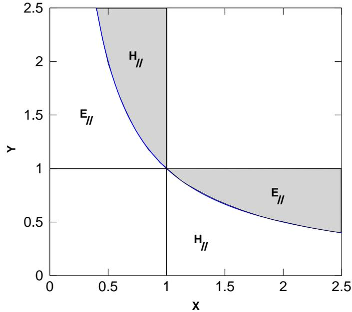
FIGURE 2.4 – Domaines d'existence des ondes de surface à l'interface entre un milieu droitier et un milieu gaucher, pour les deux polarisations, avec  $X = |\varepsilon_2|/\varepsilon_1$  et  $Y = |\mu_2|/\mu_1$ . Les domaines grisés correspondent à des ondes de surface contra-propagatives.
