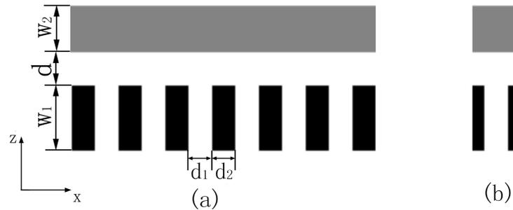
FIGURE 3.29 – (a) Le guide diélectrique et la couche de cristal photonique sont séparés par une distance  $d$ . (b) Cellule élémentaire. Pour les exemples numériques, nous avons  $d_1 = 0.5a$ ,  $d_2 = 0.5a$ ,  $W_1 = 1.4a$  et  $W_2 = 1.2a$  [Ye et al., 2009].
