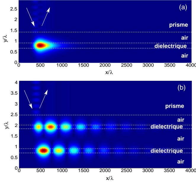
FIGURE 1.12 – Le faisceau incident (waist :  $100\lambda$ , incidence :  $36.9^\circ$ ) se propageant dans un prisme ( $\varepsilon = 5$ ) excite (a) un guide diélectrique, et (b) deux guides identiques couplés.
