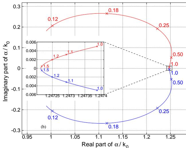
FIGURE 3.16 – Solutions de la relation de dispersion (3.21), dans le plan complexe de la constante de propagation  $\alpha$ , pour différentes valeurs de  $h_1$  (voir figure 3.15) exprimées en longueurs d'onde.
