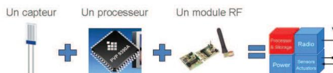
Figure 9. Eléments de base d'un nœud consommateur d'énergie
