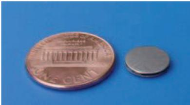
Figure I-7. Élément thermoélectrique [THE] (6 μW/°C)
