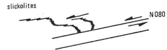
Fig. 161 : Passage d'une stries à un stylolite : "slickolites".
