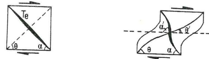
Fig. 88 : Variations progressives des angles repères  $\alpha'$  et  $\theta'$  dans le cas de déformation inhomogène.
