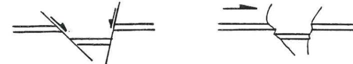
Fig. 37 : Torsion des fractures de Riedel lorsque le cisaillement est plus important que l'aplatissement.
