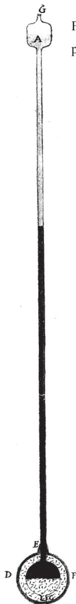
Figure 79 : Hygromètre d'Amontons
