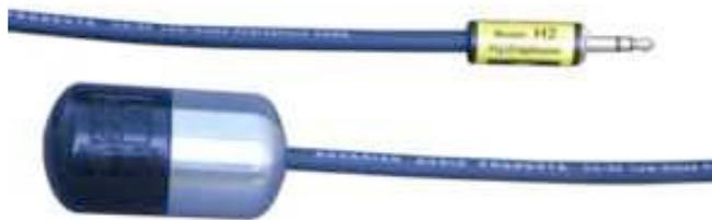
FIG. 2.6: Hydrophone utilisée dans le projet.
