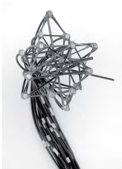
Figure 3.9: Prototype de microphone à 24 capsules permettant d'enregistrer un champ sonore tridimensionnel à partir d'un formalisme en décomposition de Fourier-Bessel. Trinnov.
