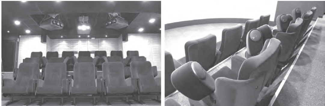
Figure 3.13: La salle immersive du Centre Scientifique et Technique du Batiment (CSTB) à Sophia Antipolis. Cette salle, de type "Reality Center", combine un système de projection stéréographique sur grand écran cylindrique, un système de reproduction sonore sur haut-parleurs "5.1" ainsi que des sièges individuellement équipés d'un système de restitution transaural (à droite). Les deux systèmes audio peuvent être utilisés simultanément. CSTB/Photo : Vincent Bourdon.
