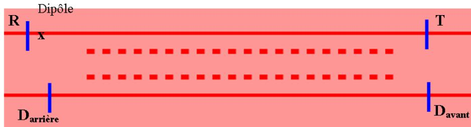
FIGURE 5.26 – *Filtre add-drop vertical composé d’un résonateur à double cristaux photoniques 1D et de deux guides identiques situés de part et d’autre de la cavité. La position du dipôle d’excitation est donnée par “x” et les symboles R, T, D<sub>avant</sub> et D<sub>arrière</sub> désignent respectivement les puissances transmises et réfléchies dans le guide Bus et les puissances transmises vers l’arrière (Backward) et vers l’avant (Forward) dans le guide Drop.*
