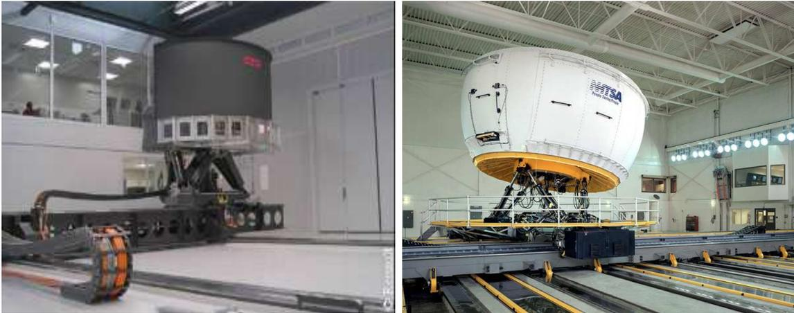
FIGURE 8.8 – *Simulateurs à structure hybride : (a) Architecture hybride du simulateur ULTIMATE de Renault - France, (b) Simulateur NADS - Iowa, USA*
