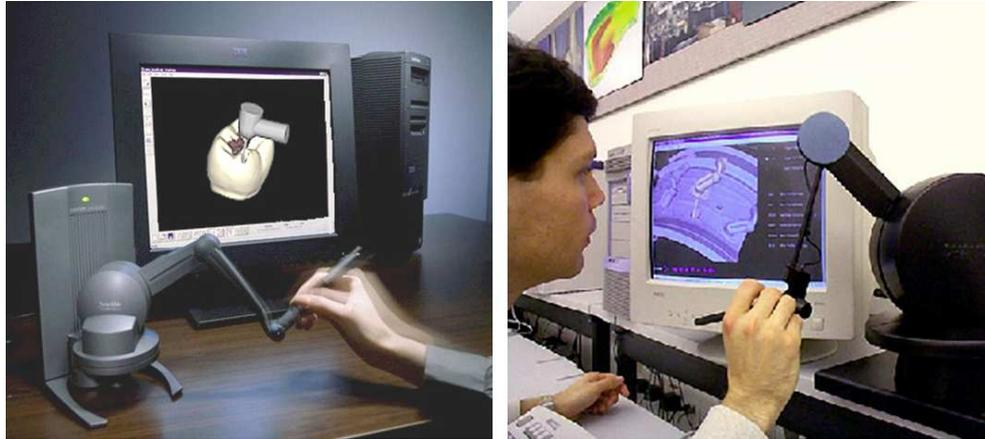
FIGURE 6.2 – Deux types de stylo PHANTOM de SensAble Technologies.
