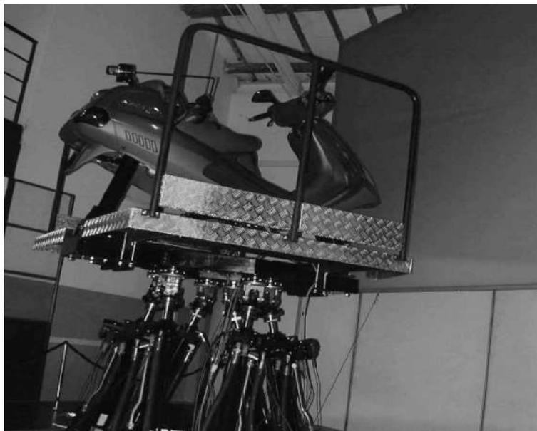
FIGURE 8.22 – *Simulateur MORIS du laboratoire Percro - Italie*
