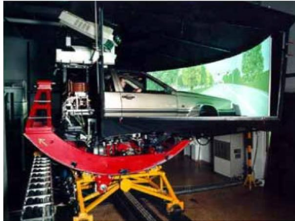
FIGURE 8.5 – Simulateur à structure série de VTI - Suède
