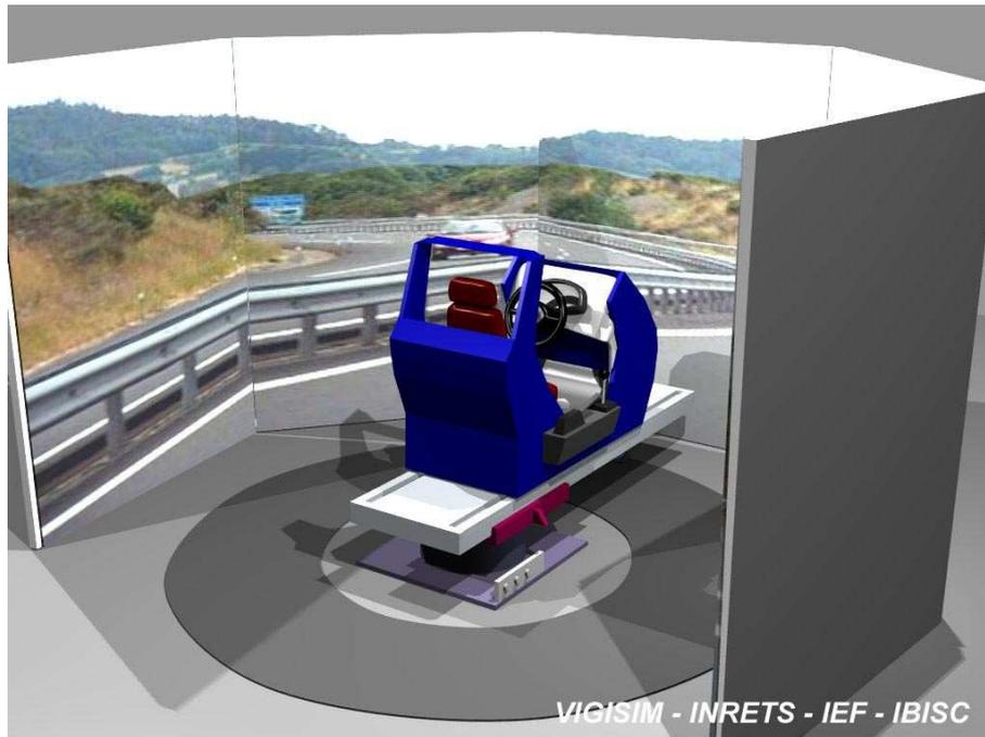
FIGURE 8.11 – Plate-forme Lacet à deux degrés de liberté
