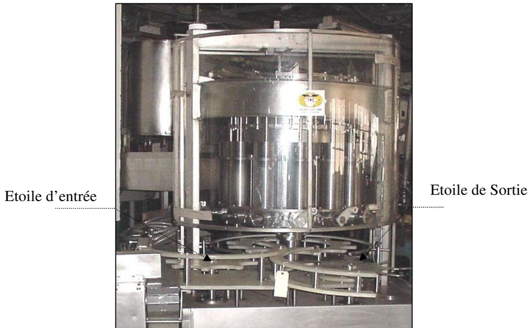
Figure III.14 : Etiqueteuse équipée d'une étoile d'entrée et de sortie [MHA, 10a]
