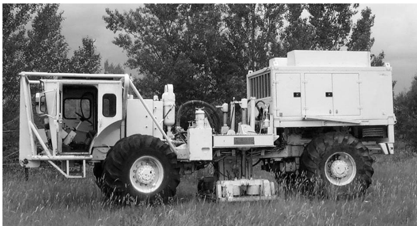
FIG. 4.39 – Camion vibreur de type Mertz22.
