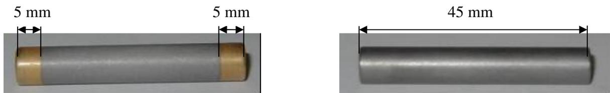
**Fig.53** : Résistances Géka avec et sans contacts en or
