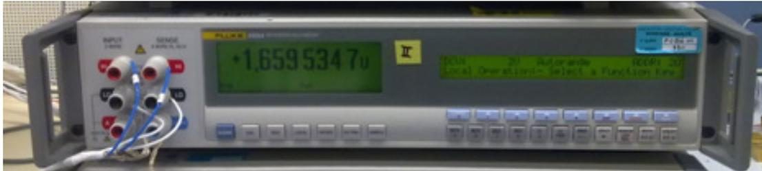
**Fig.44** : Face avant du multimètre Flucke 8508A
