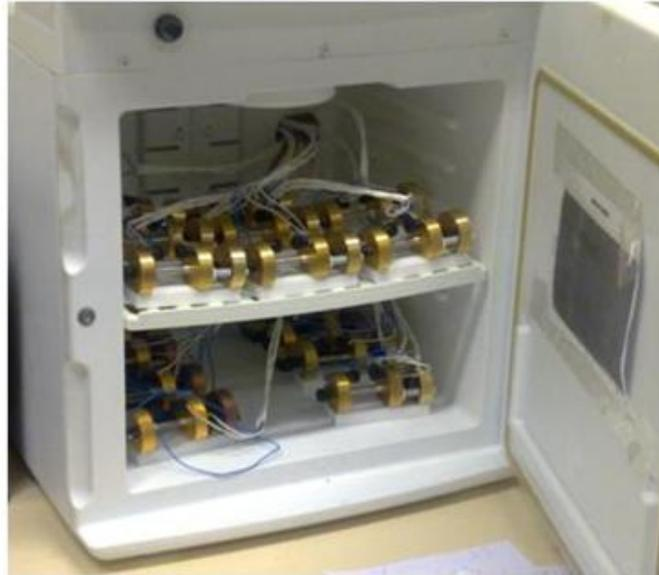
**Fig.49** : Enceinte thermo-régulée contenant 16 dispositifs de mesures 4 fils
