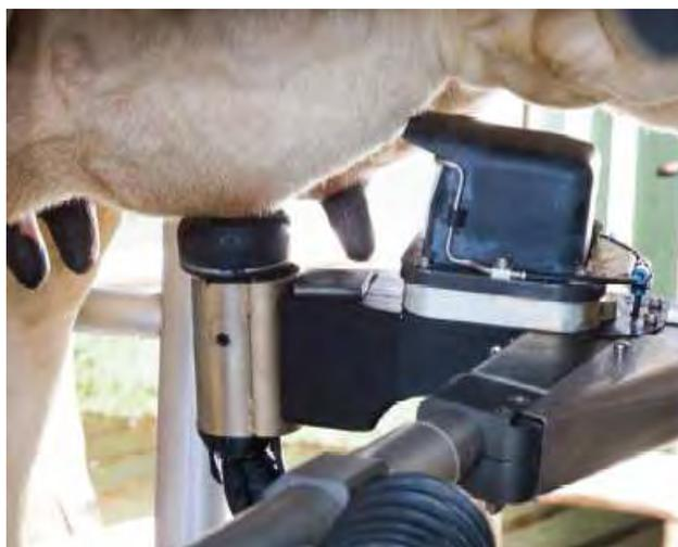
Photographie 3 : Système de nettoyage des trayons du robot DeLaval VMS 2007 (gobelet laveur). Sources : [www.delavalfrance.fr](http://www.delavalfrance.fr)
