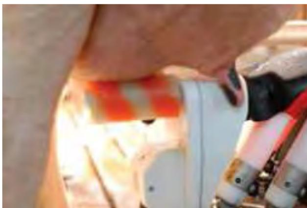
Photographie 4 : Système de nettoyage des trayons du robot Lely Astronaut A3 (brosses de nettoyage). Sources : [www.lely.com](http://www.lely.com)
