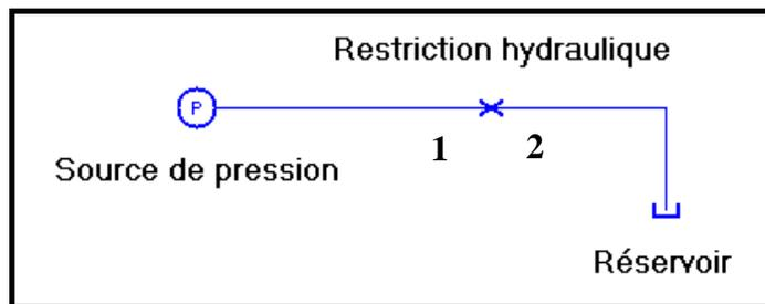
Figure 1-24: Exemple d'un circuit hydraulique sous AMESim
