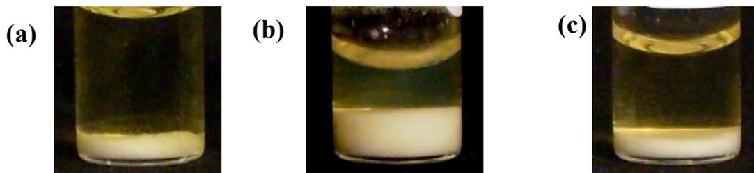
**Figure 4-24 :** Clichés montrant deux mélanges de phases lamellaire (1%) et de particules d'oxyde de cérium (3,5%) à  $\alpha_{B/A} = 0$  en (a) ; à  $\alpha_{B/A} = 0,2$  en (b) ;  $\alpha_{B/A} = 0,6$  en (c).
