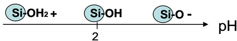
**Figure 3-1** : Schéma présentant l'état de surface de particules de silice en fonction du pH. Le point de charge nulle s'obtient à un pH de 2 environ. Au dessus, les fonctions silanols Si-OH sont majoritairement déprotonées et la surface de la particule devient chargée négativement. En dessous, ces fonctions sont majoritairement protonées et la particule devient chargée positivement.
