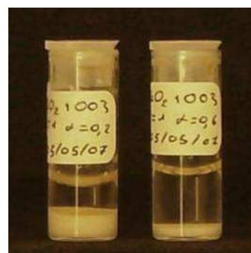
**Figure 5-6 :** Cliché montrant deux mélanges de phases lamellaires (1%) et de particules d'oxyde de cérium (3,5%). Celui de gauche est préparé à  $\alpha_{B/A} = 0$  et celui de droite, à  $\alpha_{B/A} = 0,6$ .
