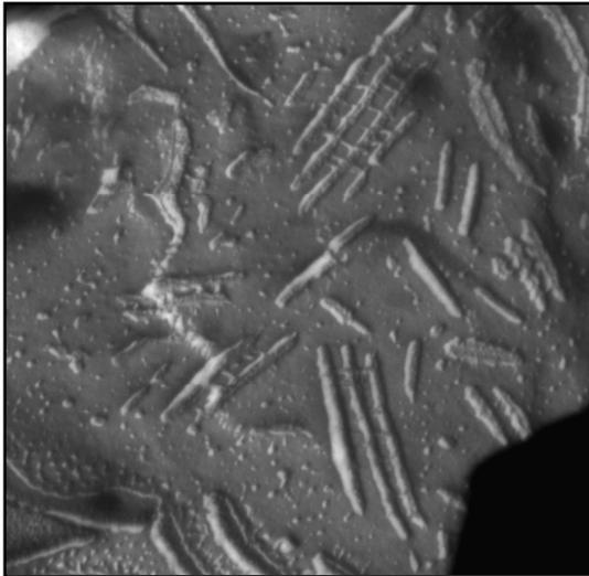
**Figure 5-13 :** Cliché MET d'une réplique de phase lamellaire qui a été dispersée dans l'eau à saturation et pour  $\alpha_{B/A} = 0,8$  en présence de 5% d'eau oxygénée. Les lignes sont les empreintes des microdomaines de PS et les zones plus lisses correspondent aux microdomaines de PAA gonflés d'eau ou aux domaines ne contenant que de l'eau.
