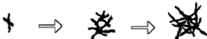
**Figure I-18 : Un schéma de croissance des agrégats d'asphaltènes [113]**
