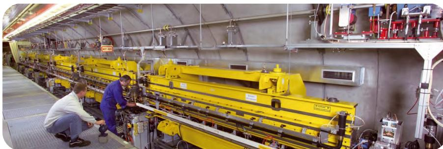
FIGURE 2.11 – Vue de l'ensemble des modules de l'onduleur de FLASH dans le tunnel de fonctionnement. Image tirée de (Schneider et al., 2007).
