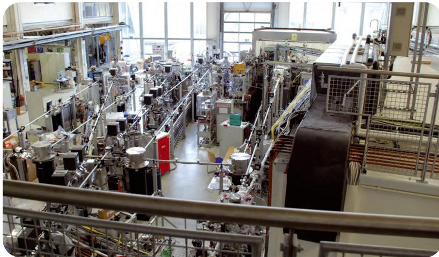
FIGURE 2.12 – Hall expérimental de FLASH avec les cinq lignes de lumière et les dispositifs de renvoi d'un laser optique pour des expériences de pompe-sonde.
