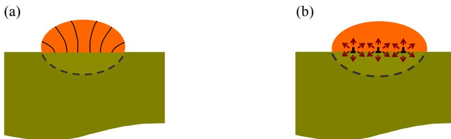
Figure II-4 : Mode d'accommodation de paramètre de maille a) par déformation élastique du germe b) par la formation d'un réseau dislocation interfaciale
