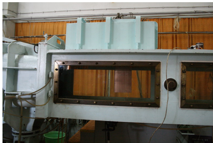
Figure 5.2. Photo de la veine d'essais N°1 du tunnel hydrodynamique du BSHC
